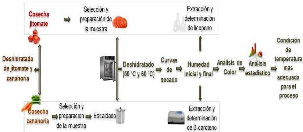
Figura 18. Diagrama a bloques de la metodología experimental.
