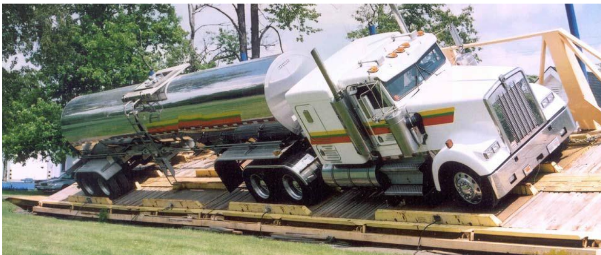
Figura 2.2. Ensayo en plataforma inclinable (Billing y Patten, 2005).
