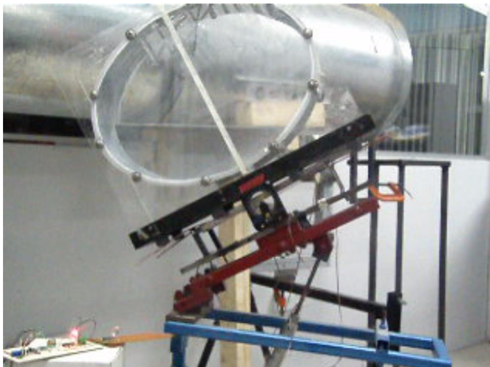
Figura 5.9. Operación de los leds en posición de volcadura y no volcadura: (a) punto estable ( led verde ); (b) volcadura inminente ( led rojo ).
