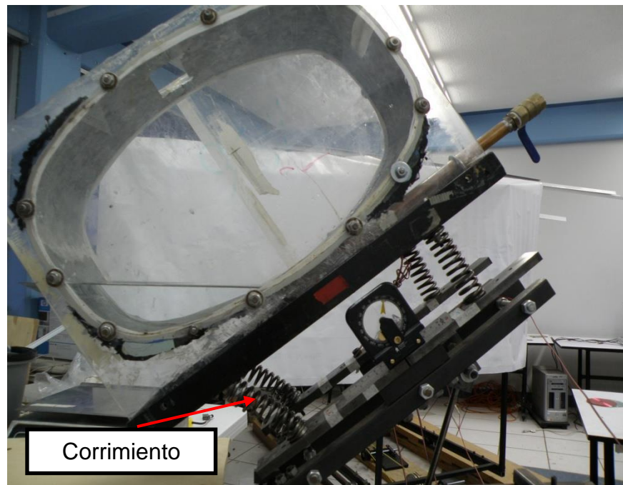
Figura 4.6. Ilustración del corrimiento lateral asociado al uso de resortes helicoidales.
