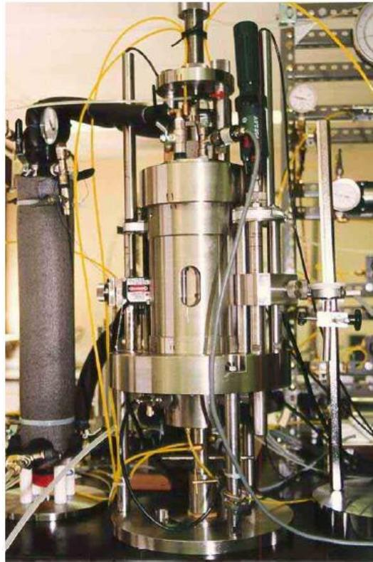
Figura 15. Foto de la célula triaxial con control de succión (Romero, 1999; Barrera, 2002).
