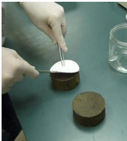
Figura 2.14 Detalle de colocación de los discos de papel filtro para obtener la succión mátrica
