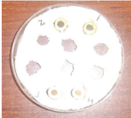
Figura E.1. Especímenes de suelo SM instalados dentro de un porta muestras
