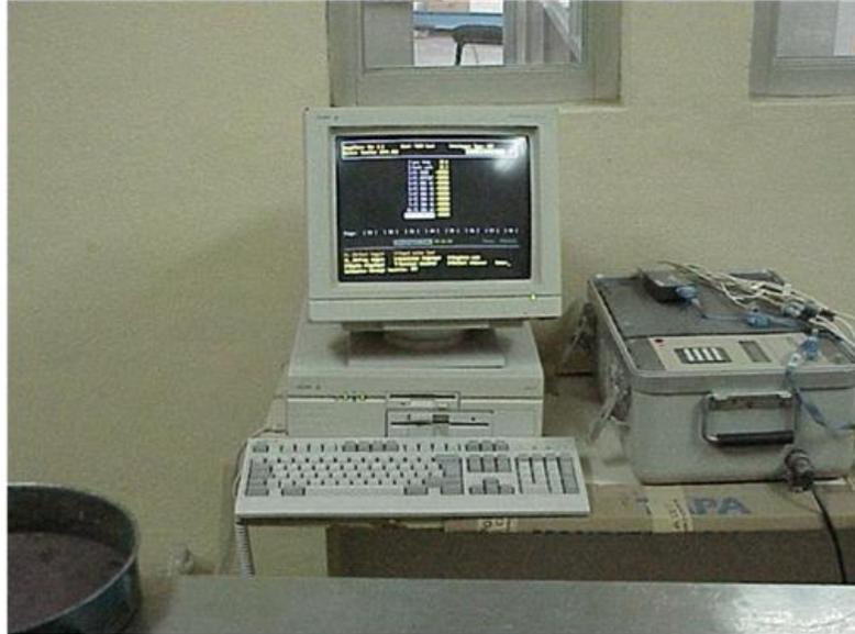
Figura 2.7 Pantalla del programa que realiza las mediciones de la succión al suelo, mediante los Psicrómetros de termopar
