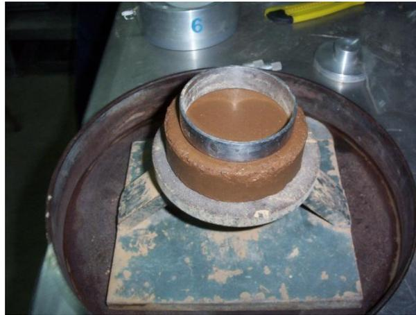
Figura 3.2 Probeta de suelo utilizada en el ensaye de consolidación
