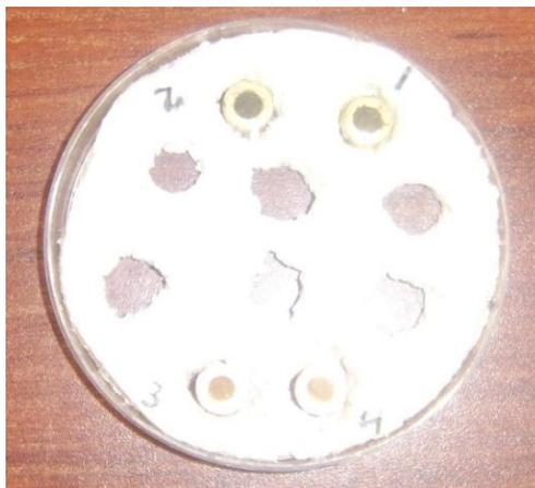
Figura 3.7 Muestra de suelo SM instalada dentro del porta muestra
