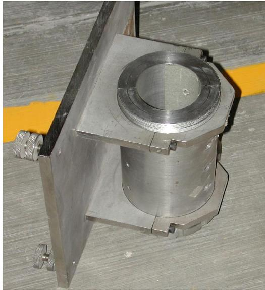
Figura 2.4 Permeámetro de perfil instantáneo
