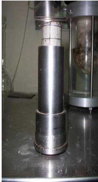
Figura 3.1 Molde utilizado para elaborar las probetas de suelo
