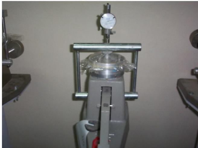
Figura 3.3 Consolidómetro convencional utilizado
