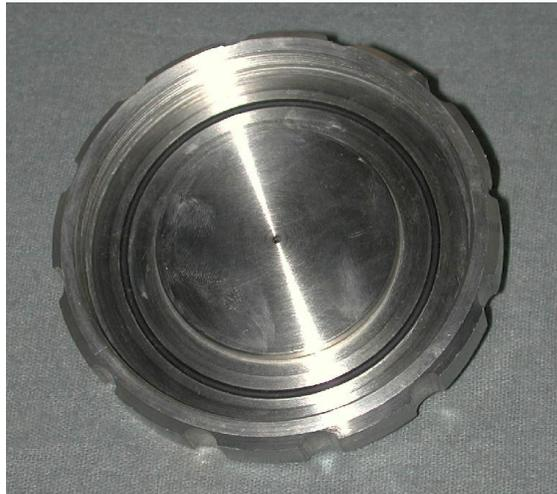
Figura 2.11 Placa hermética que sella los extremos del permeámetro
