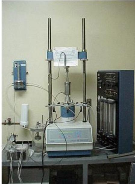
Figura 2.6 Dispositivo para suministrar el agua al permeámetro de perfil instantáneo
