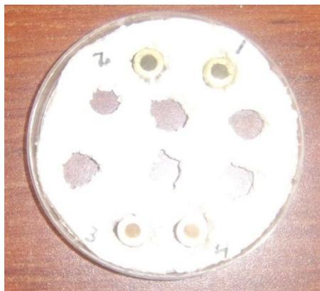
Figura A.1. Muestra de suelo SM instalada dentro de un porta muestras
