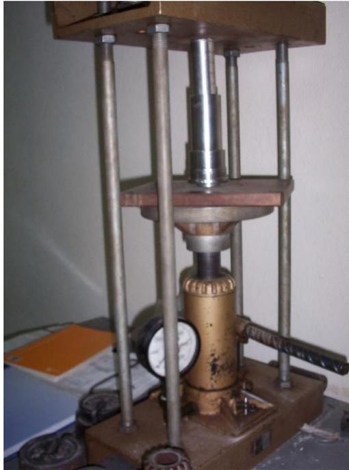
Figura C.1 Dispositivos utilizados en la fabricación de los especímenes de suelo
