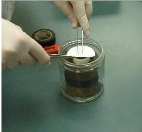
Figura 2.13 Detalle de colocación de los discos de papel filtro para obtener la succión total
