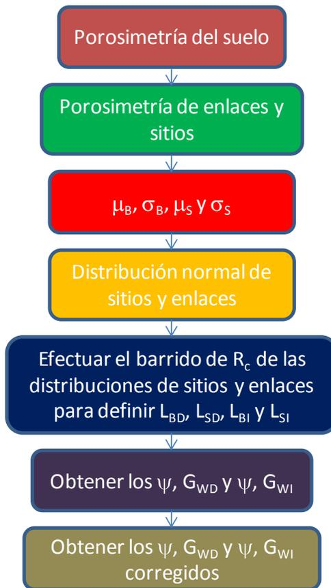
Figura F.1 Secuencia para obtener la curva característica mediante el MP
