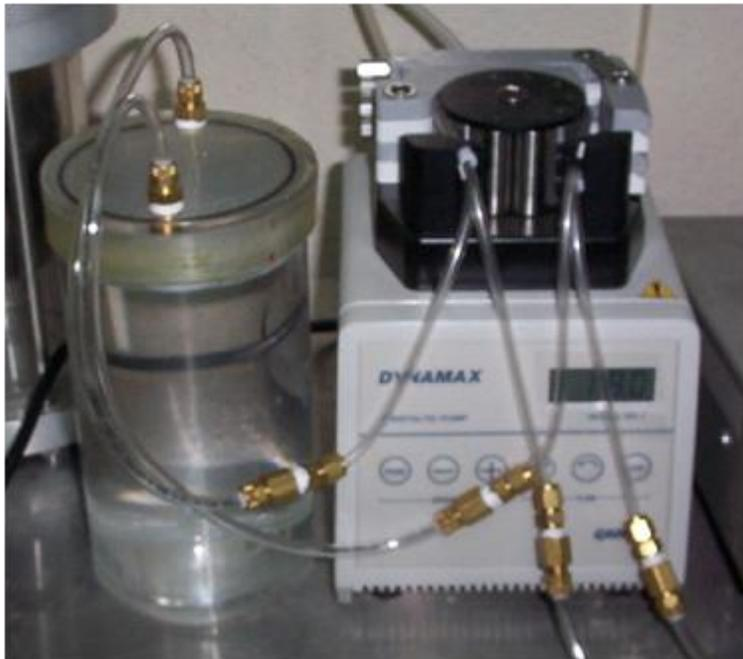
Figura C.3 Sistema para circular el vapor con succión controlada
