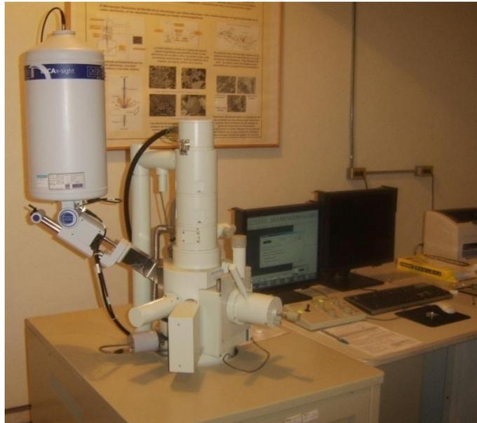
Figura A.2. Microscopio electrónico de barrido utilizado
