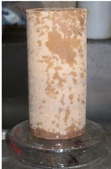
Figura C.2 Adición de agua a los especímenes de suelo mediante el aspersor
