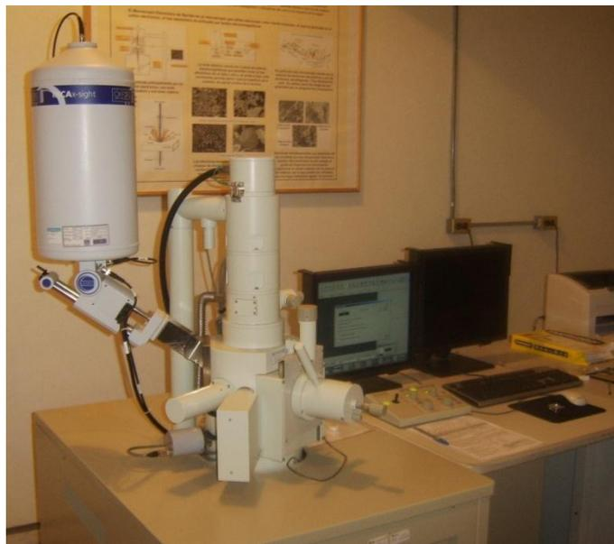
Figura 3.8 Microscopio electrónico de barrido utilizado
