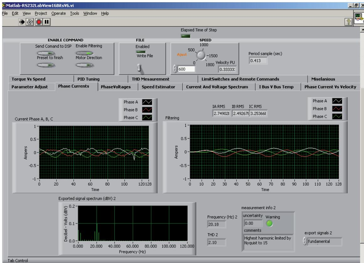
Figura 4.13: Pantalla frontal del panel remoto basado en protocolo de internet para la supervisión y adquisición de datos, mostrando las corrientes de fase consumidas en el motor y el THD que produce respectivamente, con un filtro pasa-baja ajustado en 0.12 y 0.45 de frecuencia de corte baja y alta, respectivamente.
