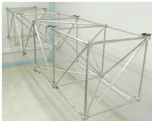
Figura 3.12. Estructura de barras articuladas.
