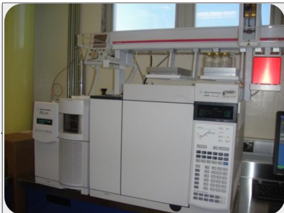
Figura 8. Cromatógrafo de gases 7890A (Agilent Technologies, Inc., California, EUA) acoplado a un espectrómetro de masas 5975C (Agilent Technologies, Inc., California, EUA), equipado con un auto-muestreador MPS2 (Gerstel Inc., Maryland, EUA)
