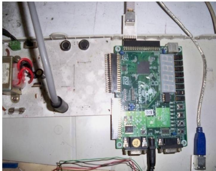
Figura 4.9. FPGA de adquisición de vibración.
