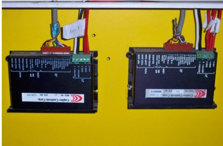
Figura 4.3 Servoamplificadores Copley Controls modelo 413.
