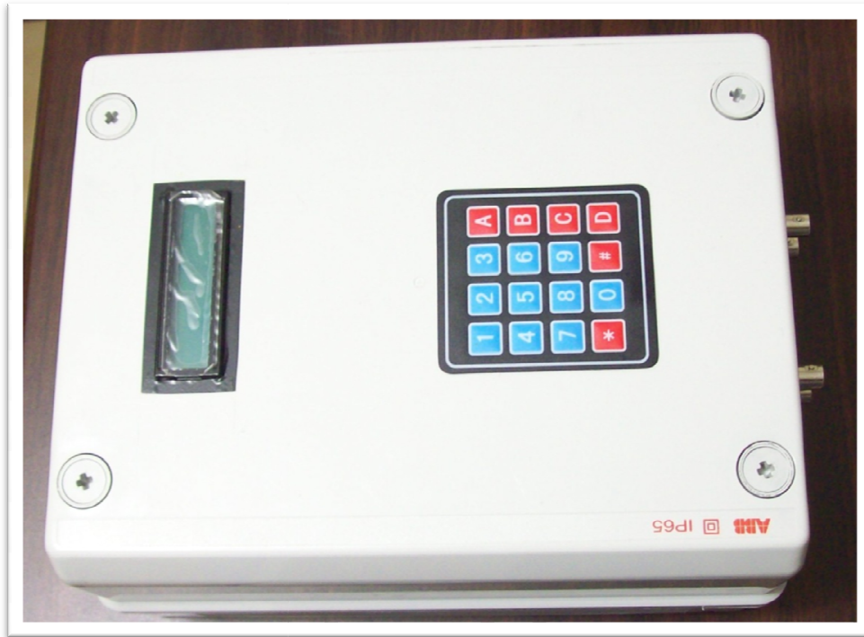
Figura 3.42 – Vista del chasis del equipo diseñado, se observa la pantalla LCD y el Pad Numérico, pueden observarse a la derecha los conectores BNC para la Entrada y Salida de las señales
