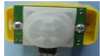
d) Sensor presencia
