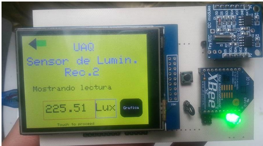
Figura 40 Vista superior de la tarjeta para monitoreo, tomando muestras de luminosidad.
