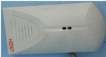
c) Sensor rotura vidrios
