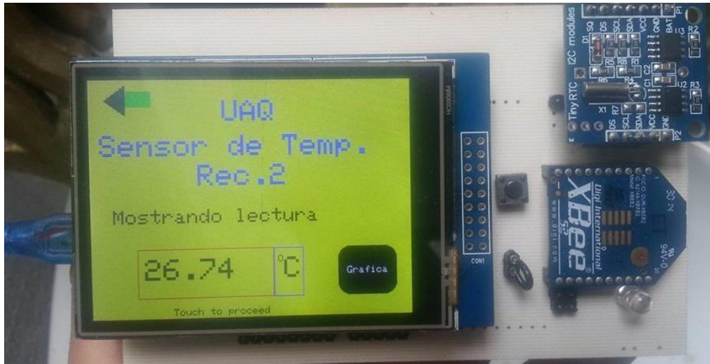
Figura 39 Vista superior tarjeta para monitoreo, tomando muestras de temperatura.
