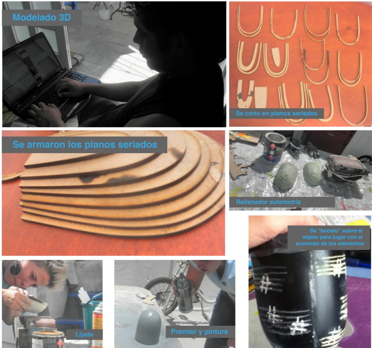
Fig. IV.1.-Construcción de la maqueta a escala.
