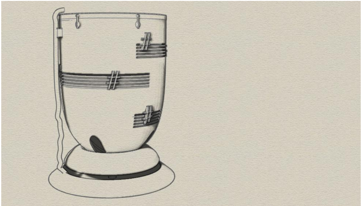
Fig. III.13.4.-Solución Final. Vista lateral demostrando la inserción de la manguera en la base-contenedor y colocación de los herrajes.
