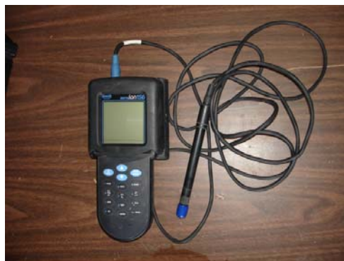
Figura 45. Equipo de medición para comparar las mediciones de temperatura y oxígeno disuelto.
