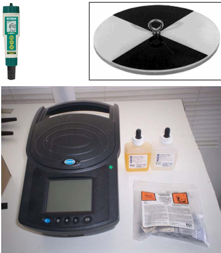
Figura 46. Equipos para medición de pH, Turbidez y Amonio.
