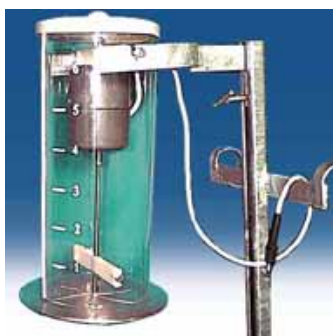
Figura 14. Alimentador para primera etapa con disco giratorio.
