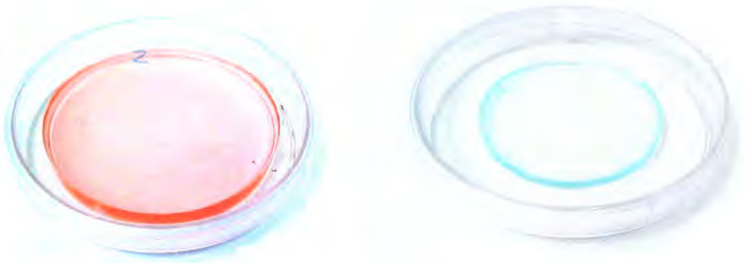
Figura 3.2 Matrices de sílice en proceso de secado. El tono del color se debe a las impurezas incorporadas (a) impurezas de \text{Fe}_2\text{O}_3 , (b) \text{CuCl}_2 .
