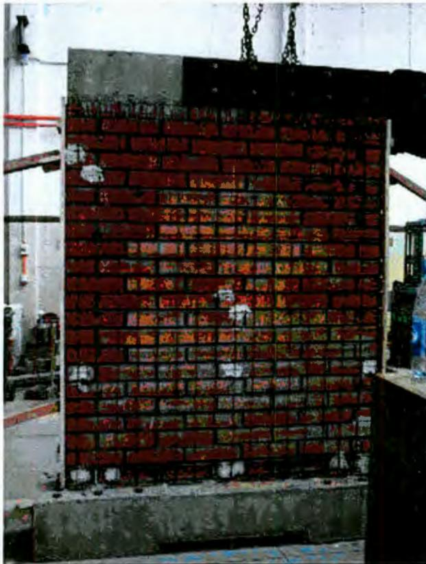
**\*Figura 30.** Muro No. 4 con malla ACMA instalada
