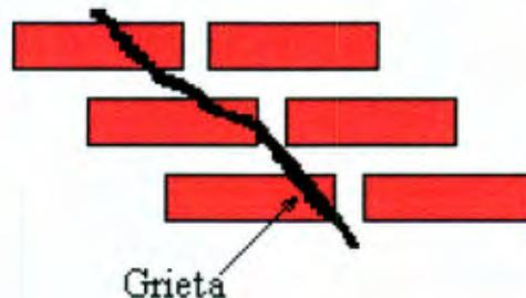
**Figura 19.** Grieta que rompe al mortero y al ladrillo
