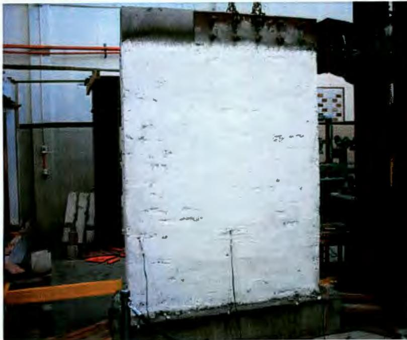
**\*Figura 32.** Muro No. 3 con instrumentos instalados para ensayo.
