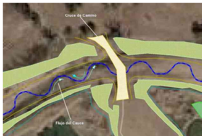
Figura 36. Cruce de camino en el río.
