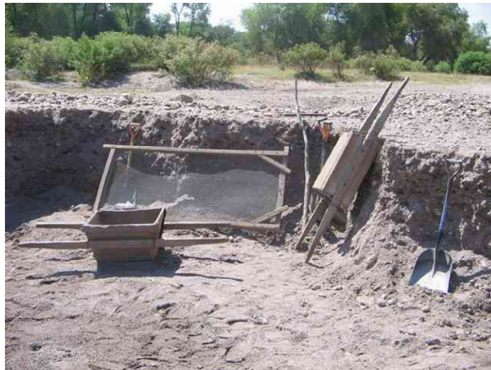
Figura 29. Herramienta de trabajo de los paleros. Harnero, parigüela, pala y pico.
