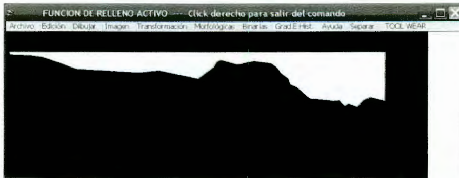
Figura 3.9 Procesamiento de imágenes. a) Umbralización y b) rellenado de área.
