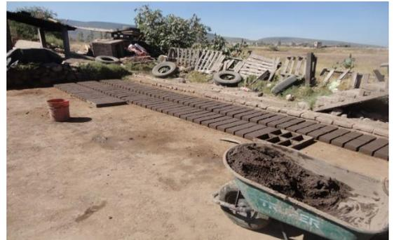
Figura 3. Moldeado de ladrillos.
