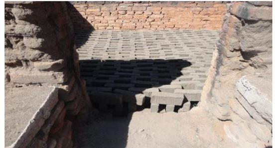
Figura 5. Cargado de horno
