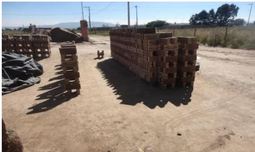
Figura 6. Secado de ladrillo.
