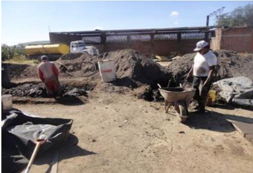
Figura 4. Mezcla de arcillas.
