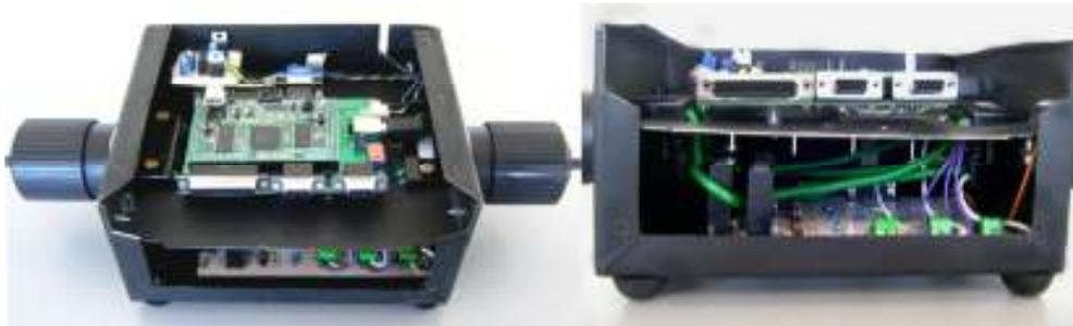
Fig. 19. Sistema de monitoreo eléctrico basado en FPGA
