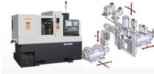
Fig. 7. Torno cabezal móvil o suizo
