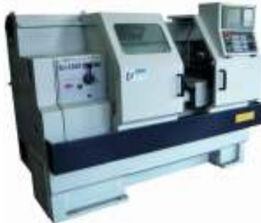
Fig. 5. Torno de bancada plana
