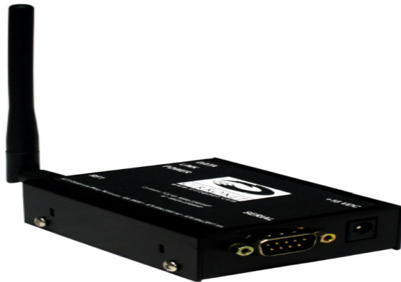
Figura C4. Módulo Cirronet ZN241Z IEEE 802.15.4 [38]
