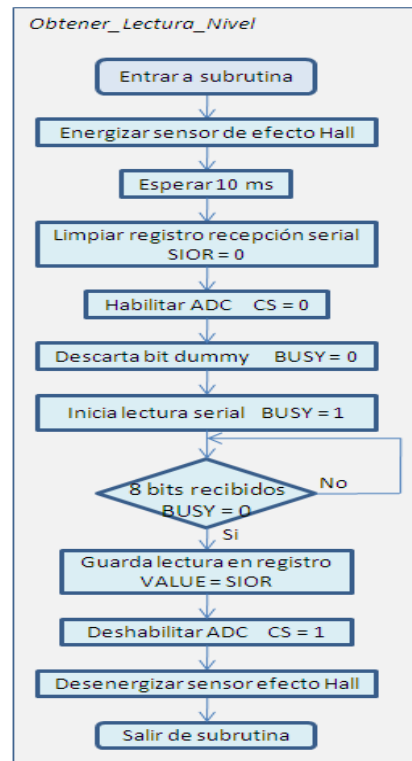
Figura 51. Diagrama de flujo de lectura del sensor de efecto Hall del transmisor propuesto
