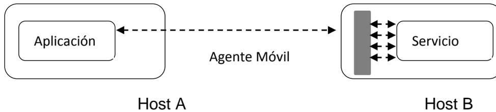
Figura 1 Agentes Móviles y la reducción en la carga de la red (Lange B. D., Oshima M., 1999). Se hace una comparación entre la constante comunicación de dos nodos con RCP (sobre carga en la red) y la comunicación de ida y vuelta (menos carga en la red) entre dos nodos con Agentes Móviles.
