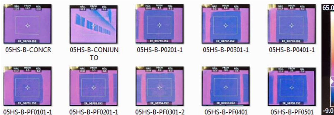
Fig. 5.4.1.2.16. Imagen termográfica de los diferentes tipos de paneles tomada a las 05:00am del día 21/03/2015
