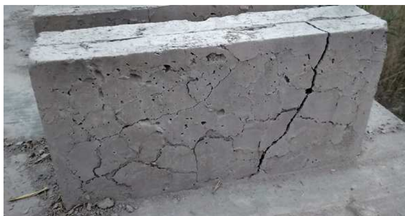
Fig. 5.4.1. Paneles PF0101 con fracturas y grietas por contracción/retracción
