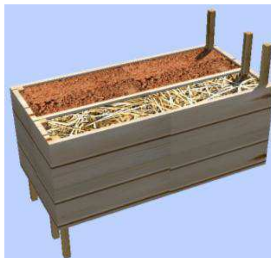
Fig. 3.5.2.3.33. Panel semiprefabricado mixto de paja y tapial con marco de madera (Ciurilenau y Horvarth, 2012)
