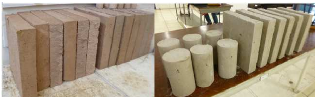
Fig. 5.3.1.1. Probetas cilíndricas 10x20cm y paneles 30x30cm para las pruebas para la caracterización mecánica del compuesto en su fase final.
