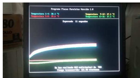
Fig. 4.5.2.2.11. Estabilización de la temperatura de las placas.
