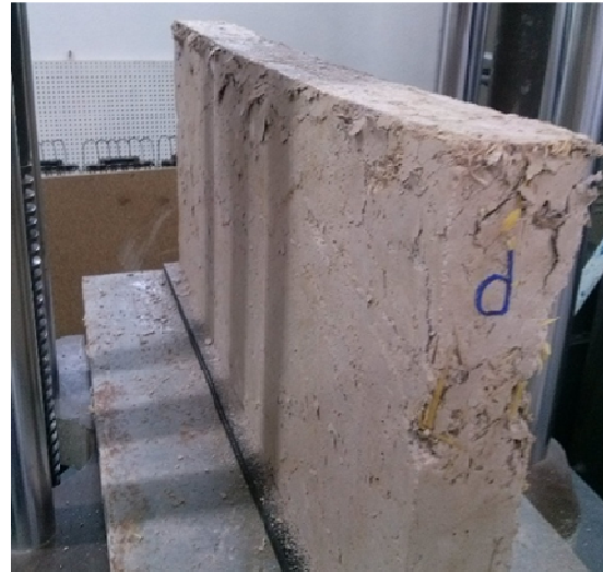
Fig. 5.4.1.1.12. Imagen de las fisuras ocasionadas en la prueba de compresión de uno de los paneles PF0103
