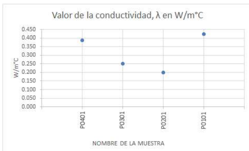
Fig. 5.4.1.2.1. Valores de conductividad de paneles del tipo de la fase previa a la final, P0401, P0301, P0201 y P0101
