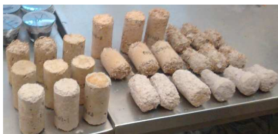
Fig. 5.3.2.14. Probetas P0201, P0202, P0203, P0301, P0302, P0303, P0401, P0402 y P0403 en la prueba de durabilidad mojado-secado en su venticinavo ciclo.
