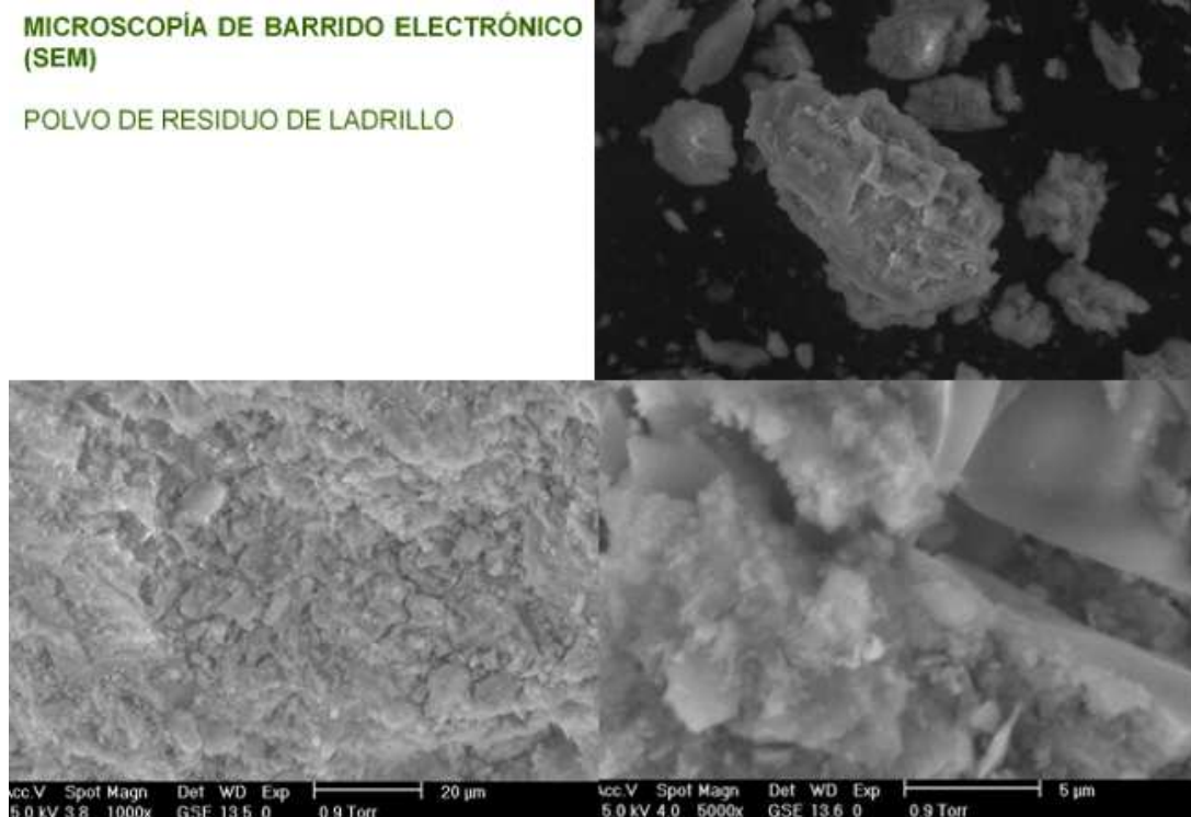
Fig. 5.2.3.7. Micrografía SEM de BD
