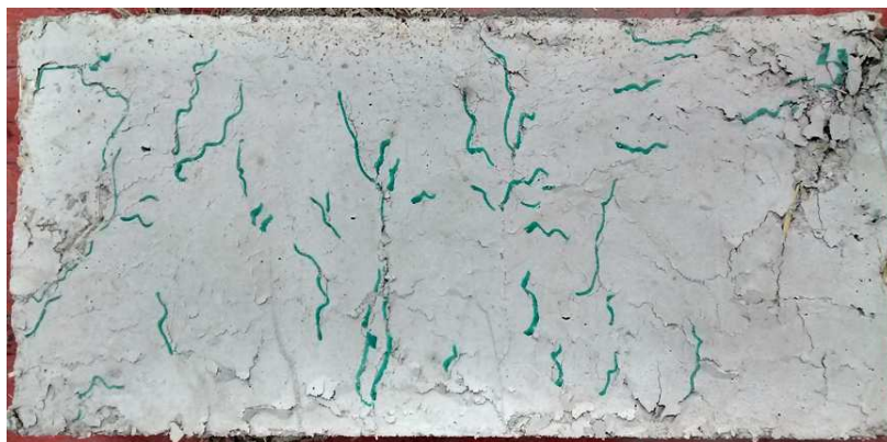
Fig. 5.4.1.1.10. Imagen de panel tipo PF0102 tras ser sometido a la prueba de compresión
