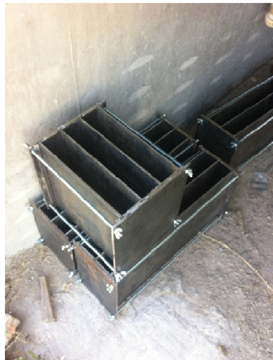
Fig. 4.5.1.1. Imagen de moldes metálicos
