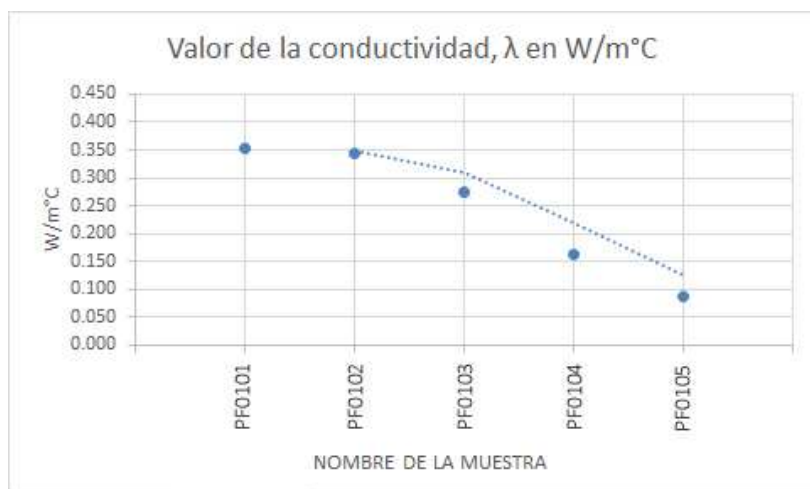
Fig. 5.4.1.2.2. Valores de conductividad de paneles del tipo PF0101, PF0102, PF0103, PF0104 y PF0105,
