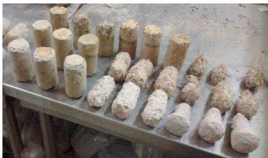
Fig. 5.3.2.8. Probetas P0201, P0202, P0203, P0301, P0302, P0303, P0401, P0402 y P0403 , en la prueba de durabilidad mojado-secado en su quinceavo ciclo.
