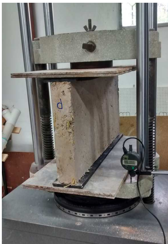
Fig. 5.4.1.1.8. Prueba de compresión con medición de deformación
