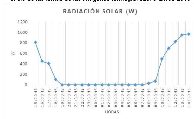
Fig. 5.4.1.2.21. Resumen de las condiciones de Radiación sobre el plano horizontal el día de las tomas de las imágenes termográficas, el 21/03/2015
