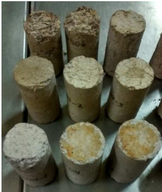
Fig. 5.3.2.16. Probetas P0401, P0402 y P0403 en la prueba de durabilidad mojado-secado en su último ciclo.
