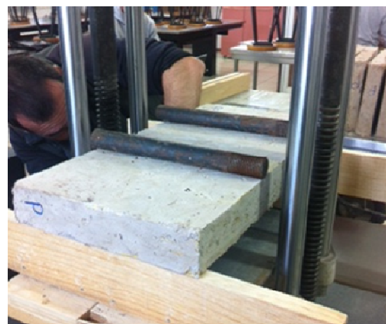
Fig. 4.5.2.1.5. Esquema de aplicación de esfuerzos para los ensayos a flexión vertical
