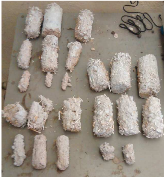
Fig. 5.3.2.15. Probetas P0201, P0202, P0203, P0301, P0302, P0303, P0401, P0402 y P0403 en la prueba de durabilidad mojado-secado en ambiente sulfatado en su vigesimo ciclo.
