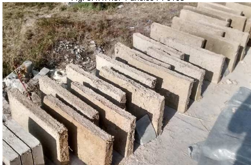
Fig. 5.4.1.1.4. Paneles PF0104 en proceso de secado y curado
