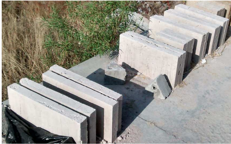
Fig. 5.4.1.1.2. Paneles PF0102 en proceso de secado y curado
