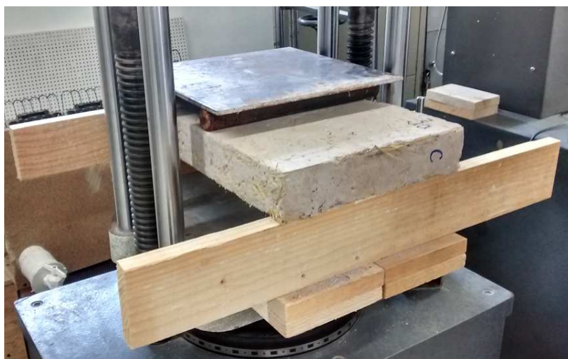
Fig. 5.4.1.1.20. Imagen de procedimiento de ensayo a flexión vertical
