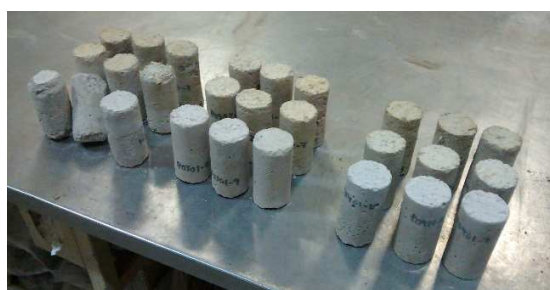
Fig. 5.3.2.4. Probetas P0201, P0202, P0203, P0301, P0302, P0303, P0401, P0402 y P0403 en la prueba de durabilidad mojado-secado en su segundo ciclo.
