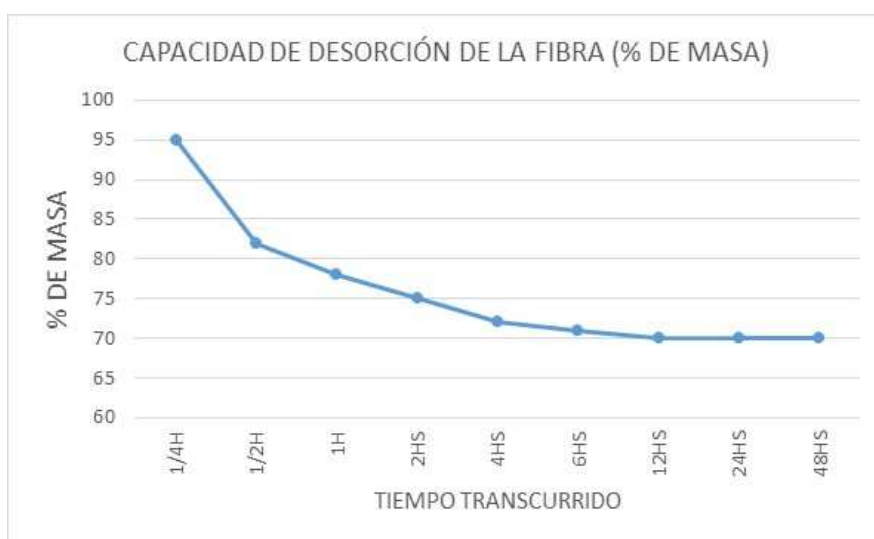
Fig. 5.2.1.3. Capacidad de desorción de la fibra medido en disminución de porcentaje de masa en un tiempo determinado
