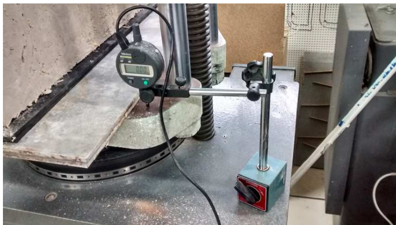
Fig. 5.4.1.1.7 Prueba de compresión con medición de deformación
