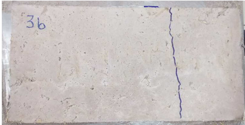
Fig. 5.4.1.1.22. Imagen de las fisuras ocasionadas en la prueba de flexión vertical de uno de los paneles PF0103
