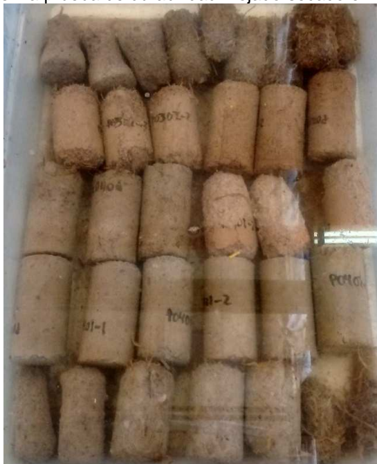
Fig. 5.3.2.6. Probetas P0201, P0202, P0203, P0301, P0302, P0303, P0401, P0402 y P0403 sumergidas en la prueba de durabilidad mojado-secado en su cuarto ciclo.
