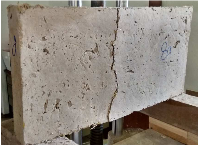
Fig. 5.4.1.1.24. Imagen de las fisuras ocasionadas en la prueba de flexión vertical de uno de los paneles PF0102
