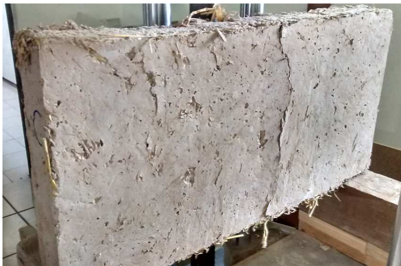
Fig. 5.4.1.1.25. Imagen de las fisuras ocasionadas en la prueba de flexión vertical de uno de los paneles PF0104
