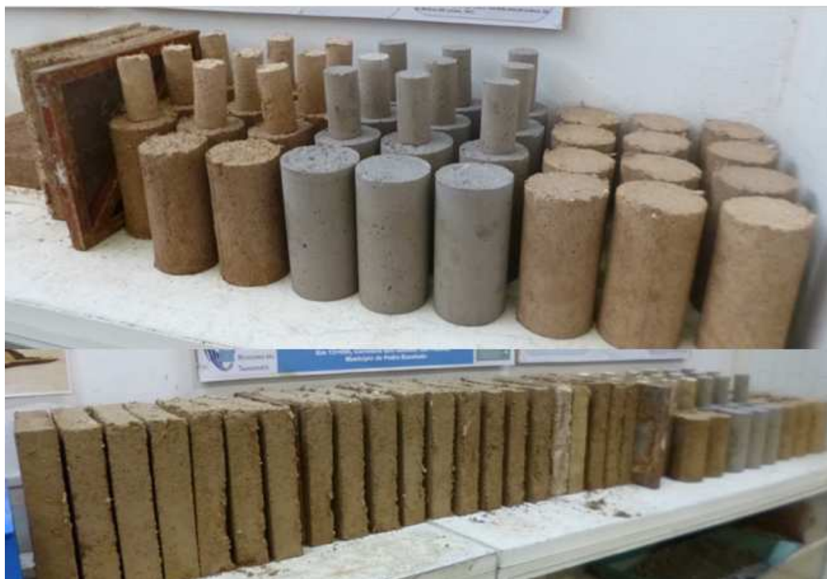
Fig. 5.3.1.2. Probetas cilíndricas 10x20cm y paneles 30x30cm para las pruebas para la caracterización mecánica del compuesto en su fase final.
