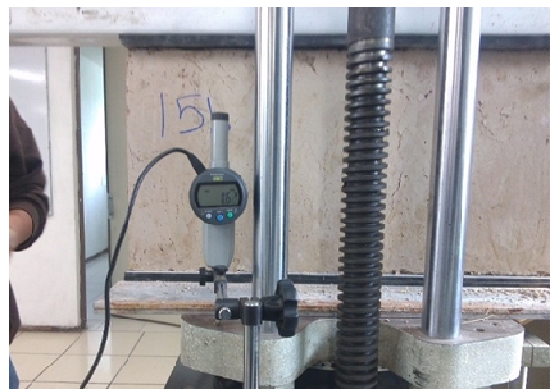
Fig. 4.5.2.1.3. Imagen del deflectómetro con el que se miden las deformaciones
