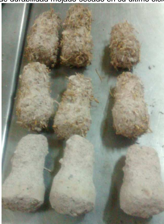
Fig. 5.3.2.18. Probetas P0201, P0202 y P0203 en la prueba de durabilidad mojado-secado en su último ciclo.
