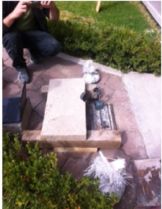
Fig. 4.5.2.1.6. Esquema de aplicación de esfuerzos para los ensayos a impacto
