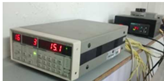
Fig. 4.5.2.2.6. Tarjeta DAQ-ACPC-1216 con termopares y Controlador de temperatura Watlow SD.
