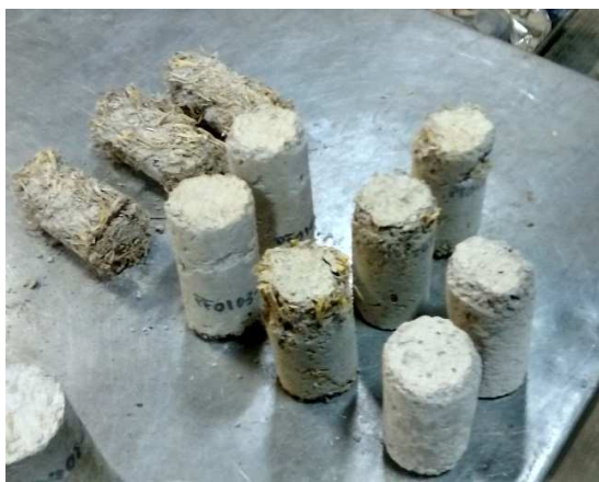
Fig. 5.3.2.7. Probetas PF0101, PF0102, PF0103 y PF0104, en la prueba de durabilidad mojado-secado en ambiente sulfatado en su sexto ciclo.
