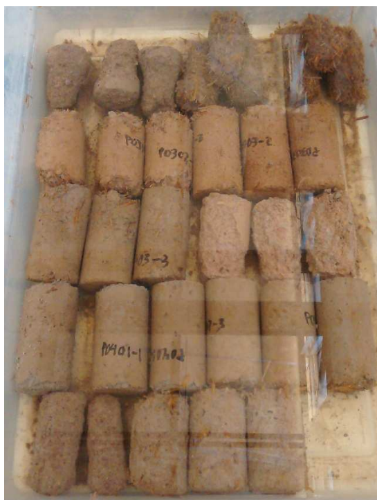
Fig. 5.3.2.13. Probetas P0201, P0202, P0203, P0301, P0302, P0303, P0401, P0402 y P0403 sumergidas en la prueba de durabilidad mojado-secado en su decioctavo ciclo.
