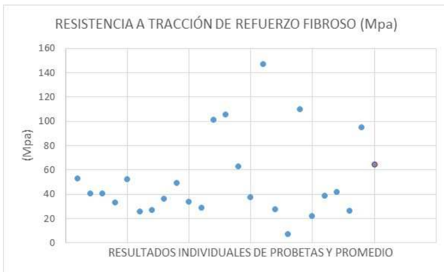
Fig. 5.2.1.5. Resistencia a tracción de la fibra en Mpa.
