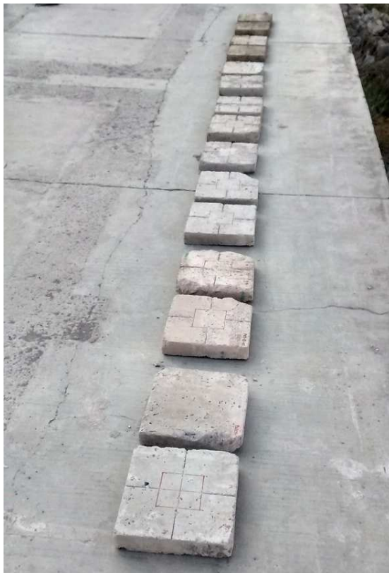
Fig. 5.4.1.2.11. Paneles predispuestos sobre firme de concreto para la prueba de termografía.
