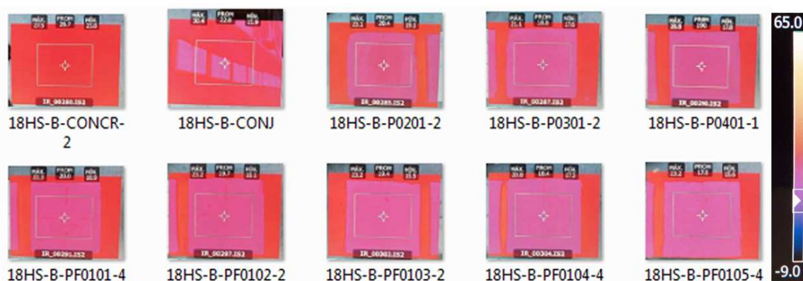
Fig. 5.4.1.2.18. Imagen termográfica de los diferentes tipos de paneles Tomada a las 06:00pm del día 21/03/2015
