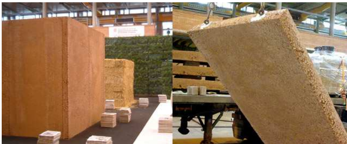
Fig. 3.5.2.3.38. Panel prefabricado mixto de paja y cáñamo (www.cannabric.com).
