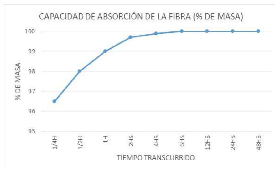
Fig. 5.2.1.2. Capacidad de absorción de la fibra medido en aumento de porcentaje de masa en un tiempo determinado
