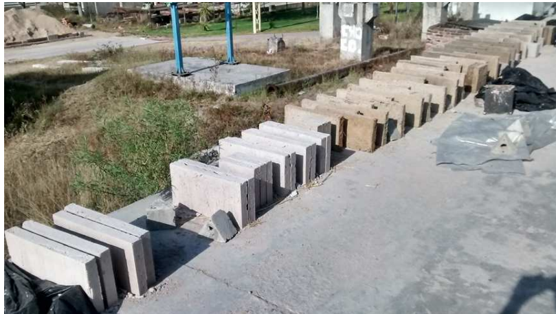
Fig. 5.4.1.1.1. Paneles de la serie final PF, en proceso de secado y curado.
