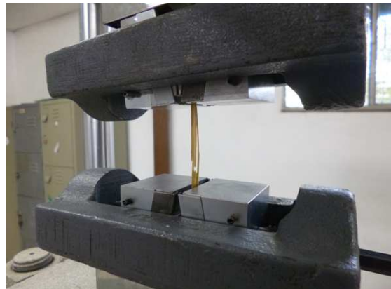
Fig. 4.1.2.1.6. Ejemplo de rotura de probeta de paja de cebada.
