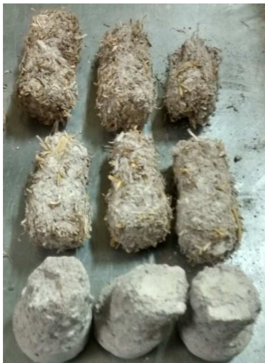
Fig. 5.3.2.17. Probetas P0301, P0302 y P0303 en la prueba de durabilidad mojado-secado en su último ciclo.
