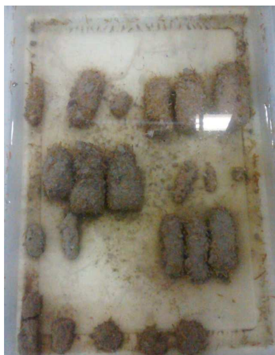
Fig. 5.3.2.12. Probetas P0201, P0202, P0203, P0301, P0302, P0303, P0401, P0402 y P0403 sumergidas en la prueba de durabilidad mojado-secado en ambiente sulfatado en su decioctavo ciclo.
