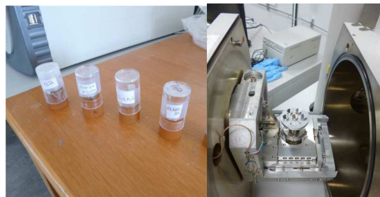
Fig. 4.3.1.7. Introducción de muestras en equipo para análisis SEM.
