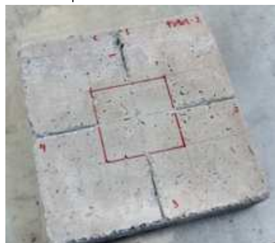
Fig. 4.5.2.2.9. Preparación del panel para la colocación de los termopares en ambas caras de la probeta.
