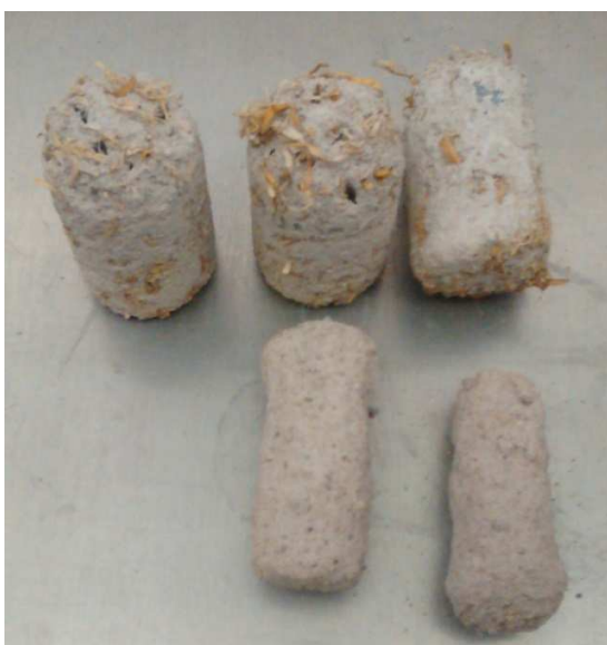
Fig. 5.3.2.10. Probetas PF0101, PF0102, PF0103 y PF0104, , en la prueba de durabilidad mojado-secado en su quinceavo ciclo.
