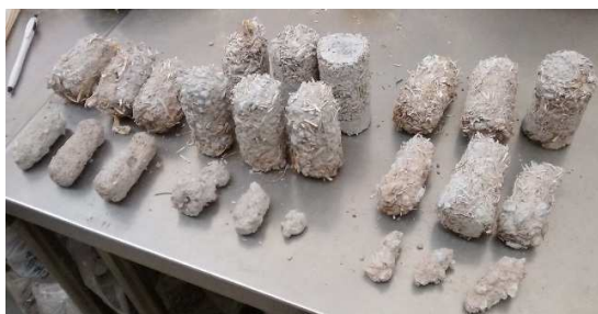
Fig. 5.3.2.9. Probetas P0201, P0202, P0203, P0301, P0302, P0303, P0401, P0402 y P0403 , en la prueba de durabilidad mojado-secado en ambiente sulfatado en su quinceavo ciclo.
