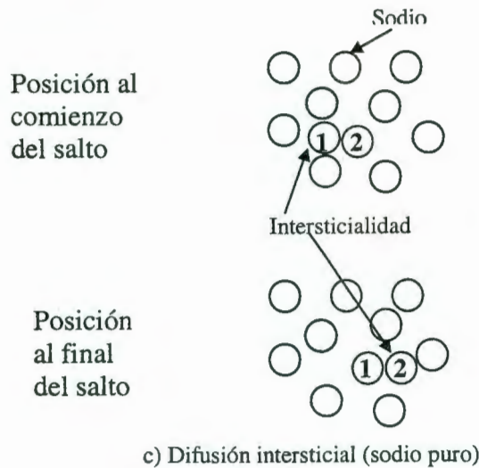
Figura 2.3c. Esquema del tercer mecanismo de difusión en cristales.
