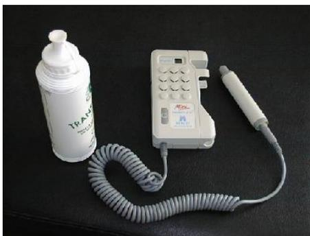
**Figura 1; doppler vascular portátil con transductor de 8 MHz marca contec**
