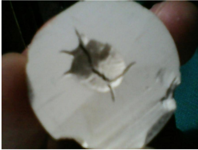
Figura 9. Bola de \text{Al}_2\text{O}_3 (S025) cortada a la mitad con un disco de diamante.
