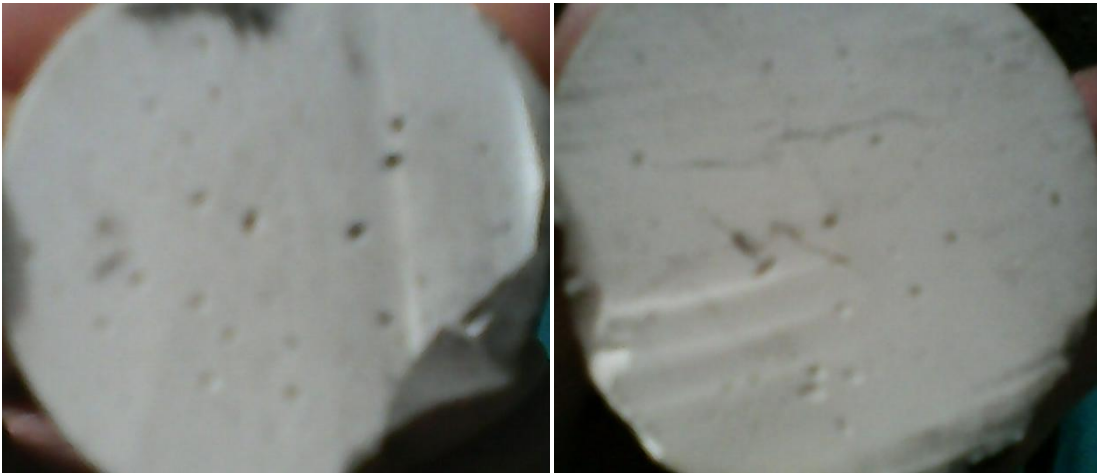
Figura 11. Bola de \text{Al}_2\text{O}_3 (G070 izquierda; G015 derecha) cortada a la mitad con un disco de diamante.
