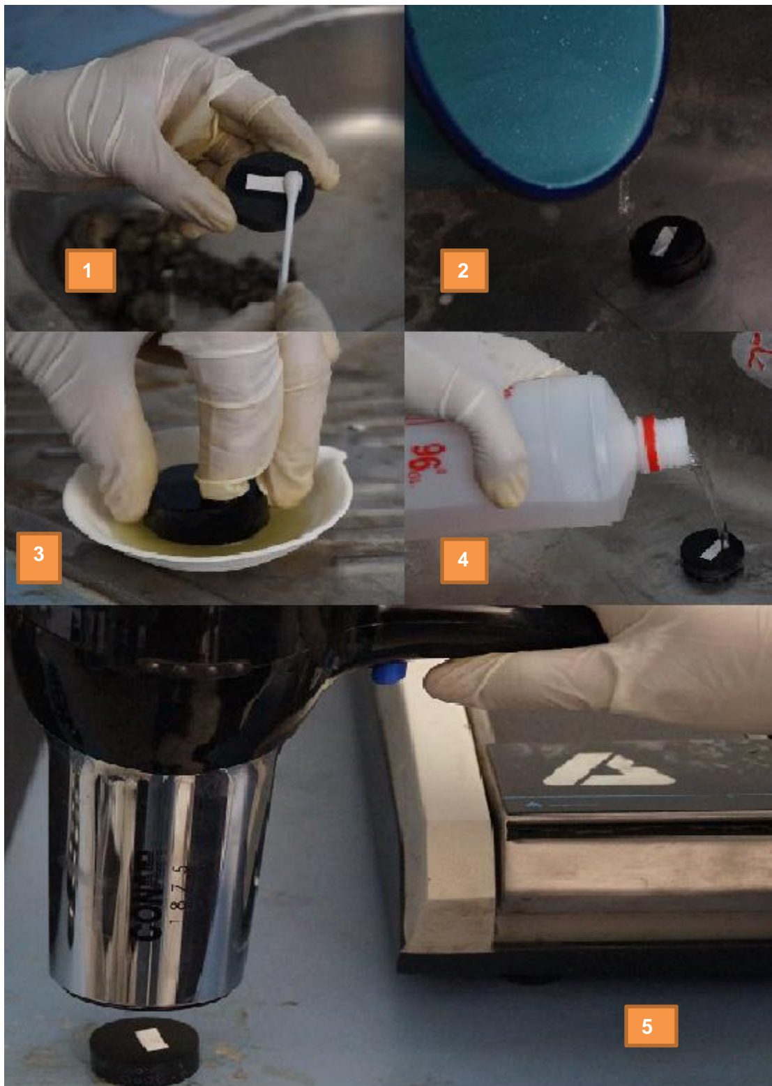
Figura (3.35) Procedimiento para revelar tamaño de grano.
