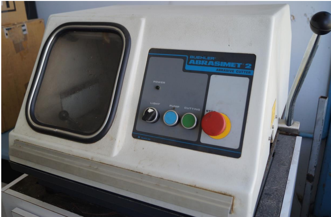
Figura (3.16) Cortadora de disco abrasivo abrasimet 2 marca buehler . UAQ.
