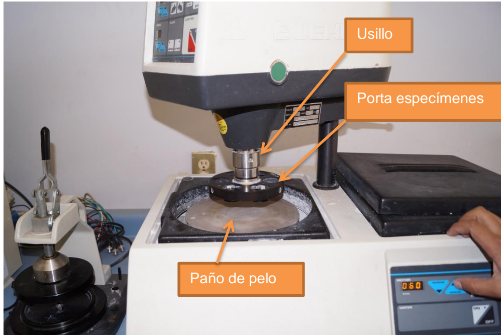
Figura (3.27) Proceso de pulido fino.
