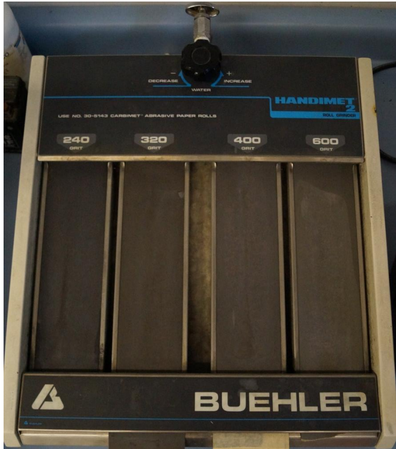
Figura (3.24) Esmeriladora manual handimet 2 marca buehler . UAQ
