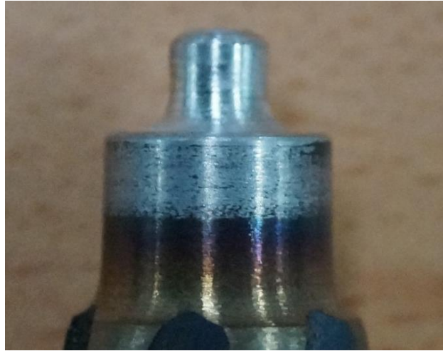
Figura (3.3) Indentador 5 mm x 5 mm.
