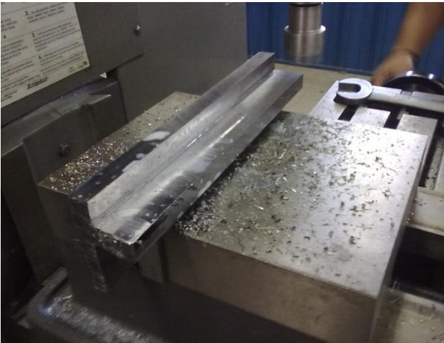
Figura (3.7) Proceso de manufactura de mordazas.
