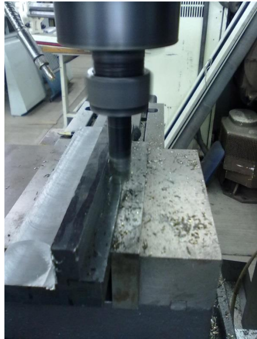
Figura (3.7) Proceso de manufactura de mordazas.
