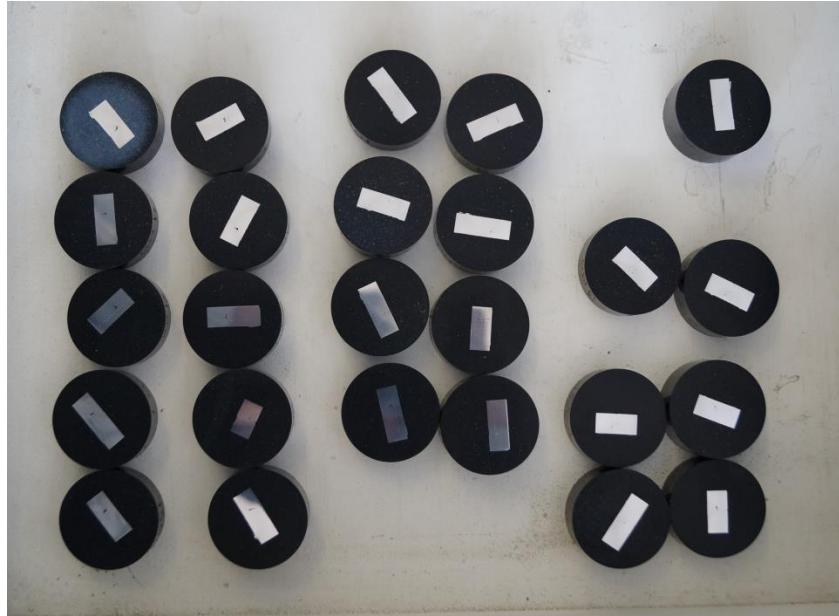
Figura (3.28) Probetas con acabado espejo.
