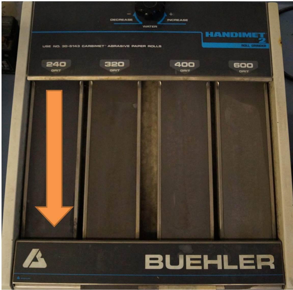
Figura (3.25) Dirección de desbaste en lijas.
