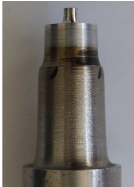
Figura (3.4) Indentador 3 mm x 3 mm.
