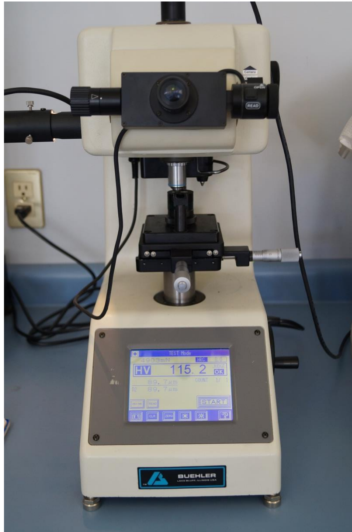
Figura (3.29) Durómetro MMT-3 marca buehler .
