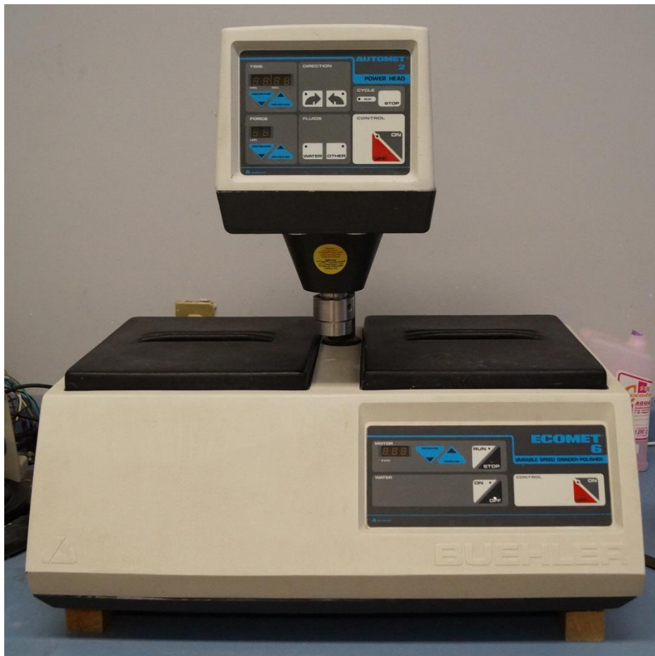
Figura (3.26) Máquina de pulido fino ecomet 6 marca buehler . UAQ
