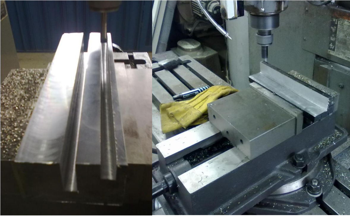
Figura (3.6) Proceso de manufactura de mordazas
