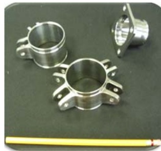
Figura 3.3. Piezas torneadas y fresadas. Fuente: personal de recursos humanos de KA.
