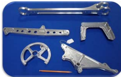
Figura 3.1. Piezas fresadas. Fuente: personal de recursos humanos de KA.
