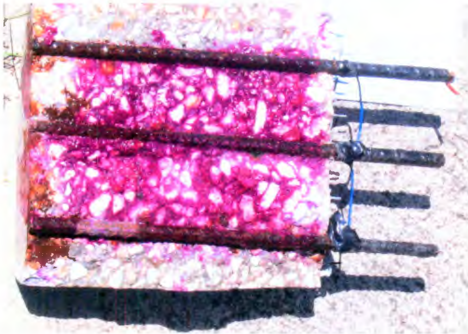
Figura 38. Probetas representativas del proceso de carbonatación en las celdas de a) 50% y b) 90% de humedad relativa.
