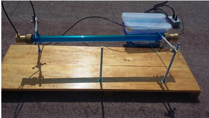
Figura 17. Fotografía del sistema fotocatalítico con luz solar.
