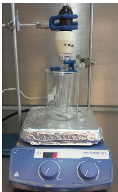
Figura 4. Sistema de reacción fotocatalítico montado para las pruebas.
