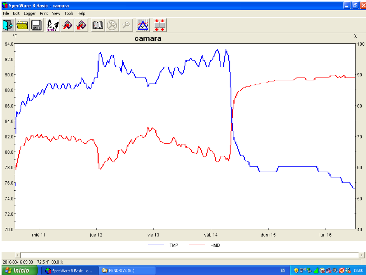
Figura 4.8. Grafica de los valores de la temperatura, humedad y tiempo del experimento corrido en la germinación de la charola con semilla de jitomate con el control automático del software de la cámara.
