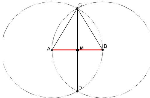
Figura 2.1: Construcción de triángulo equilátero dado uno de sus lados.
