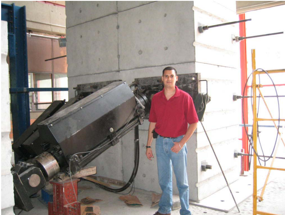
Figura 2.8.- Bloques de concreto armado y pos-tensado del muro de reacción de la UNAM.
