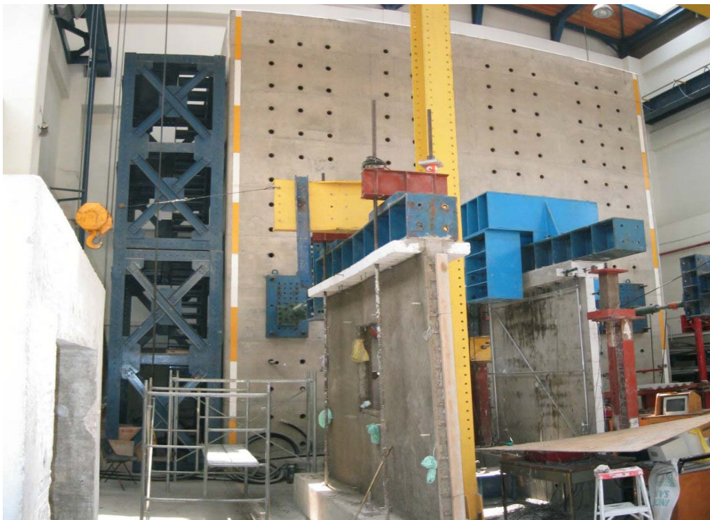
Figura 2.7.- Muro de reacción del CENAPRED.
