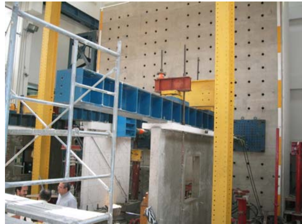
Figura C.2.- Muro de reacción del CENAPRED
