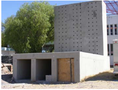
Figura 3 a) Muro de Reacción ya terminado y b) ejemplo de configuración de prueba
