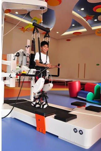
Figura 27: Entrenamiento robótico de la marcha (Lokomat) (Fundación Teletón, 2012)
