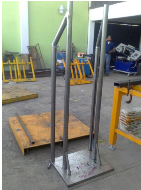
Figura 74: Esqueleto hecho en perfil de una y media pulgada, para pruebas de uso.
