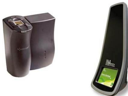
**Figura 4-1** Ejemplos de dispositivos biométricos para el reconocimiento de huellas digitales y rostro en 3D para el control de acceso físico.
