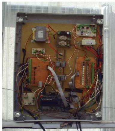
**Figura 6-6** Sistema de Control de Acceso Automatizado para Invernadero basado en FPGA.
