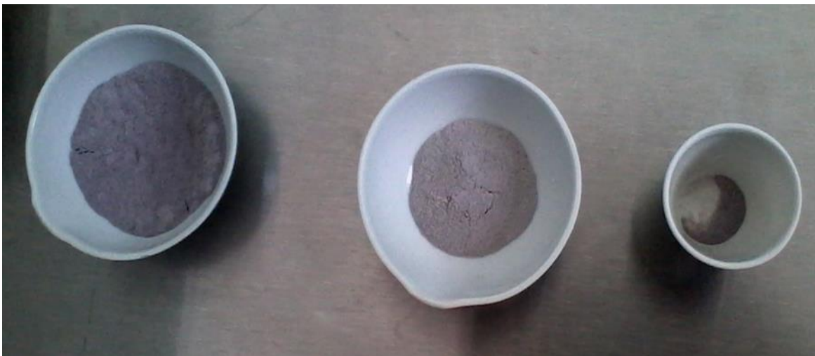
Figura 4.1.6. Muestras de \text{AgTiO}_2 a diferentes concentraciones de plata después de la calcinación a 550\text{ }^\circ\text{C} y de la pulverización con mortero
