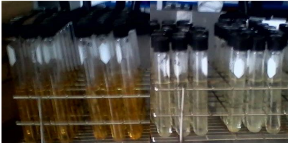
Figura 4.4.1 Tubos con medio de cultivo de caldo lauril sulfato (izquierda) y caldo lactosado (derecha) después de la inoculación.
