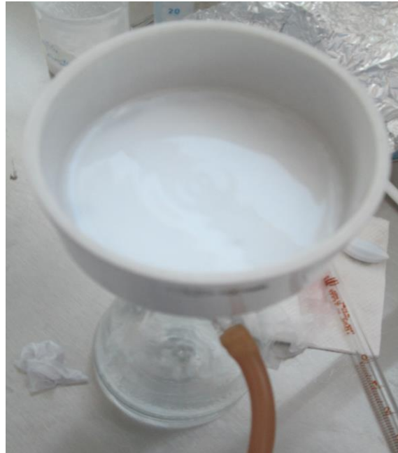
Figura 4.1.4 Lavado y filtrado de las muestras empleando una bomba de vacío para acelerar el proceso
