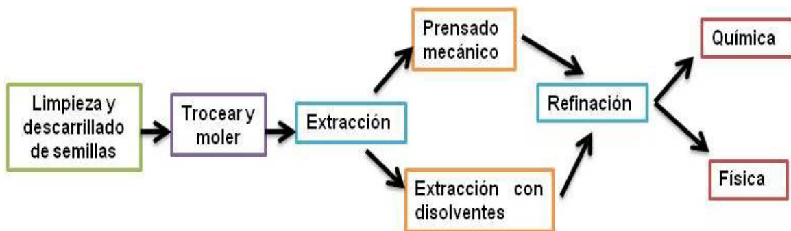
Figura 8. Diagrama de bloque de extracción de aceites
