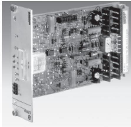
Figura 2.25. Servo amplificador comercial
