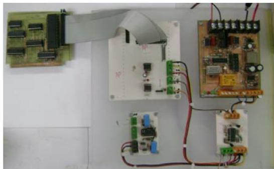
Figura 4.1. Hardware empleado en la identificación del sistema de velocidad y presión
