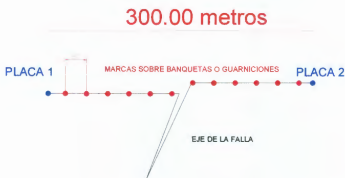
Figura 4.1 Esquema de Nivelación entre 2 placas
