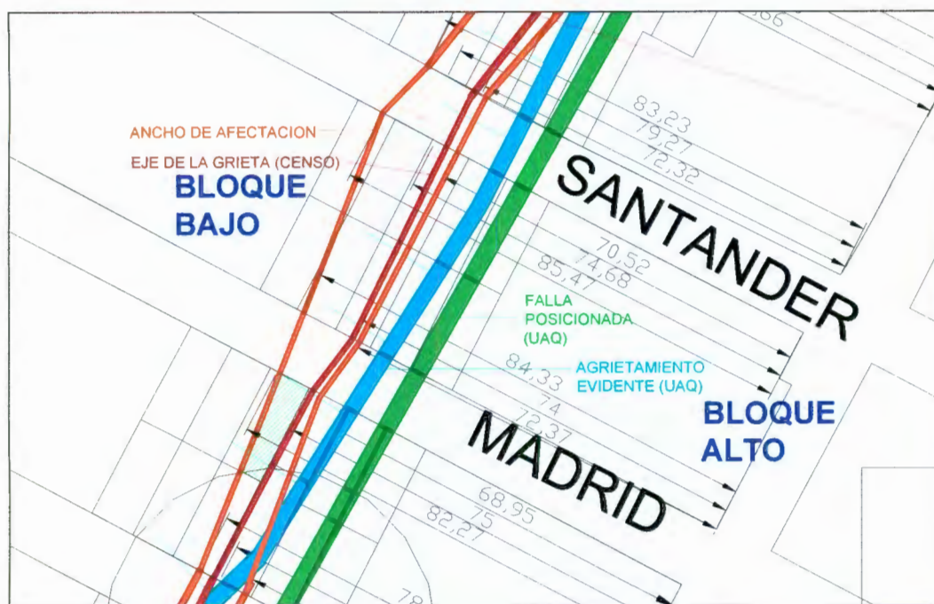
Figura 5.2 Grieta referenciada al paramento de la esquina más cercana
