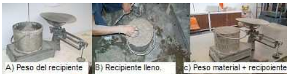
Figura 3. 21 Peso volumétrico en estado fresco.
