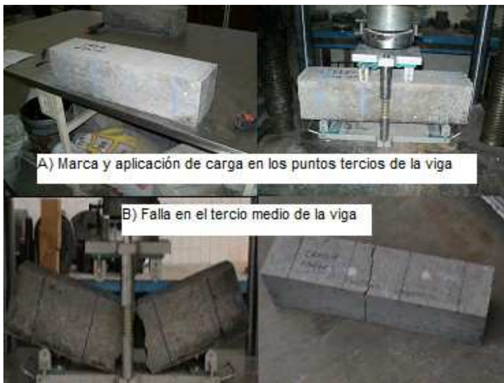
Figura 3. 23 Prueba módulo de rotura.
