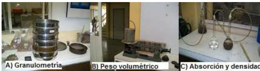
Figura 3. 13 Pruebas de granulometría, peso volumétrico, absorción y densidad de la arena.
