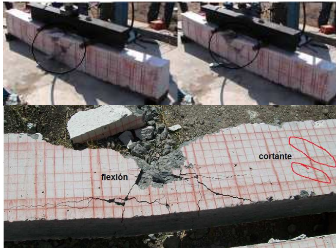
Figura 4.16 Patrón de grietas de la viga CRM2.
