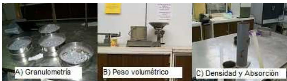
Figura 3. 14 Pruebas de granulometría, peso volumétrico, absorción y densidad de la grava.
