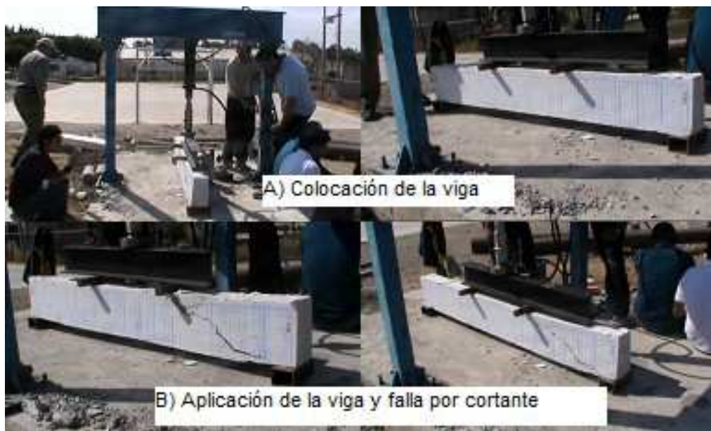
Figura 3. 24 Prueba a flexión en vigas.
