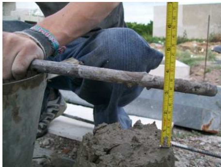
Figura 3. 20 Prueba de revenimiento en campo.
