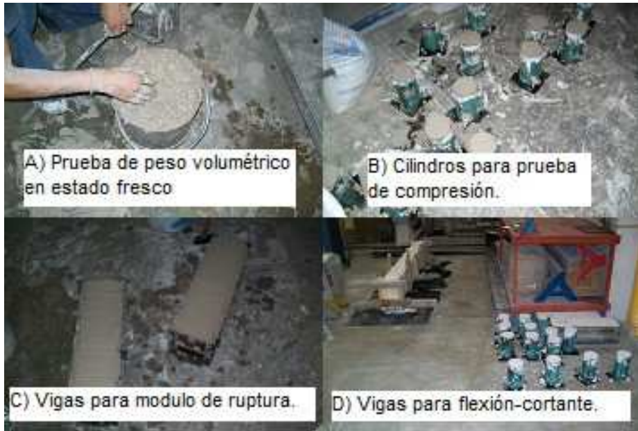
Figura 3. 19 Elaboración del concreto reciclado mejorado.
