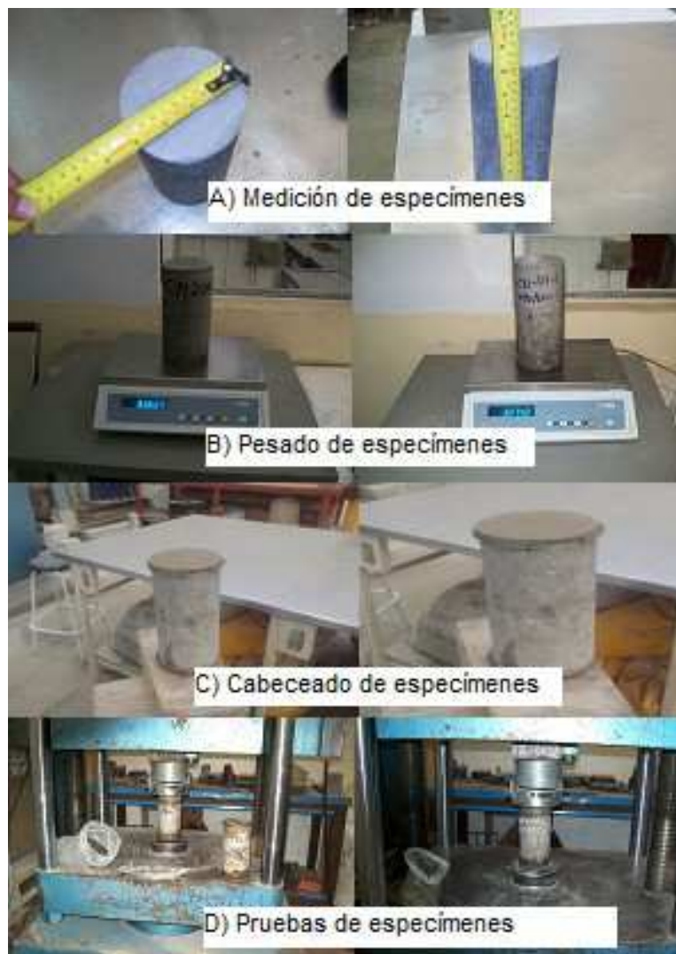
Figura 3. 22 Prueba de compresión.
