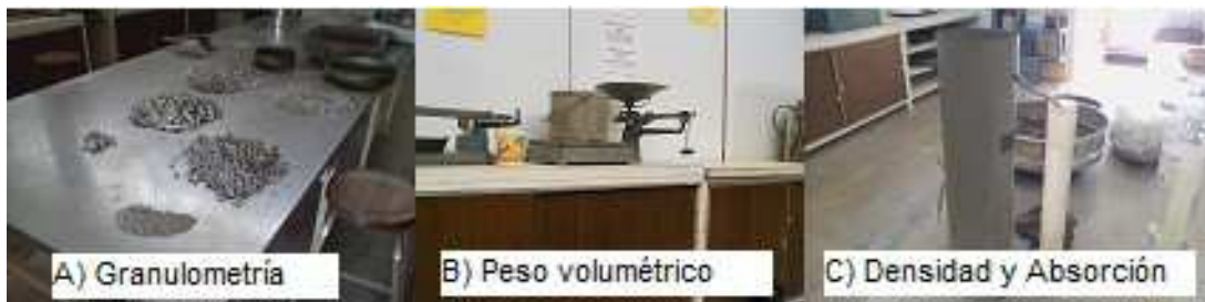
Figura 3. 17 Pruebas de granulometría, peso volumétrico, absorción y densidad del agregado reciclado.
