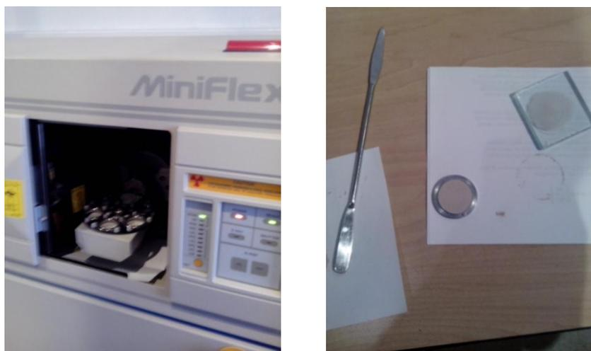
**Figura 14** Preparación de la muestra para Técnica DRX.
