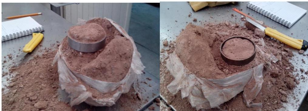
**Figura 9** Preparación del material para Pruebas (Expansión y Colapso) en muestra Inalterada.
