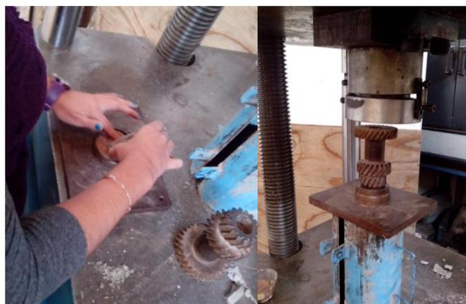
**Figura 11** Compactación Estática para pruebas de (Expansión y Colapso) en muestra Alterada.
