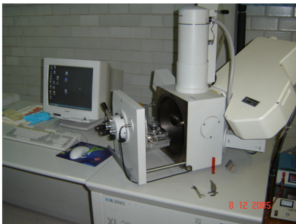
Figura 3.3. Microscopio Electrónico de Barrido acoplado a un Espectrómetro por Energía Dispersa.
