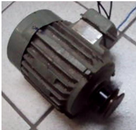
Figura 4.11. Motor trifásico de 220V AC y 2.9Amp utilizado en pruebas
