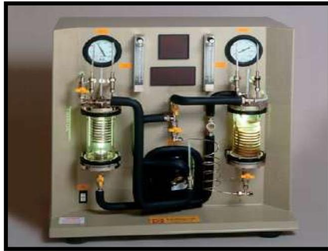
Figura 55. Unidad de demostración del ciclo de refrigeración (Fuente: catalogo P-A-Hilton Ltd., 2011.pdf).
