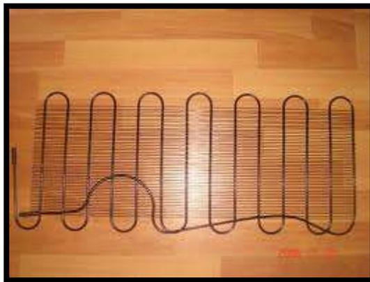
Sistema de condensación del refrigerador de 18 ft.
