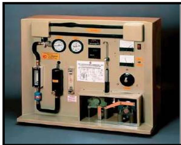
Figura 56. Unidad de refrigeración de laboratorio (Fuente: P-A-Hilton Ltd., 2011.pdf).
