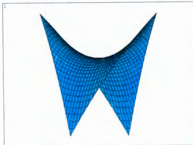
Fig 5.28 Sección Romboidal del paraboloide hiperbólico; LX = LZ = 10m Esfuerzos iniciales en X y Z = 500 T/m 2
