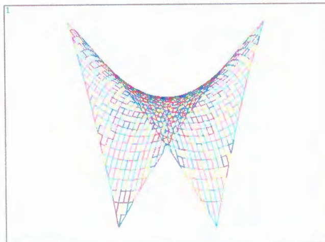
Fig 5.29 Modelo discreto. 80 Elementos Beam44; 2400 elementos link8
