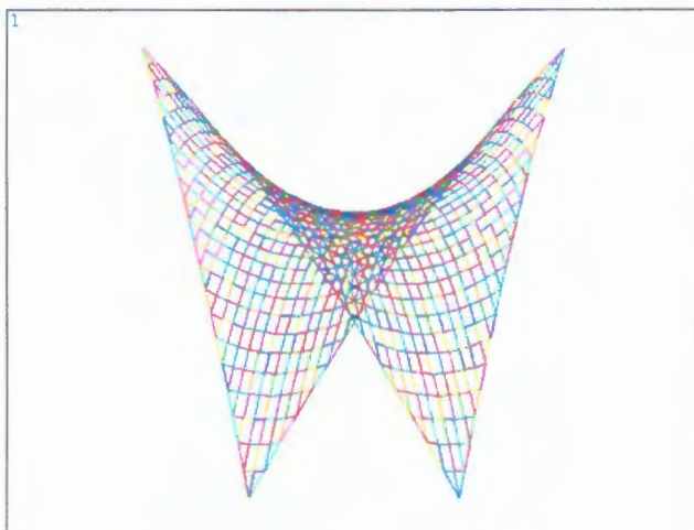
Fig 3.4 Conformación reticular de la membrana
