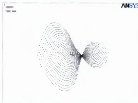
Fig 3.1 Nodos de un paraboloides hiperbólico
