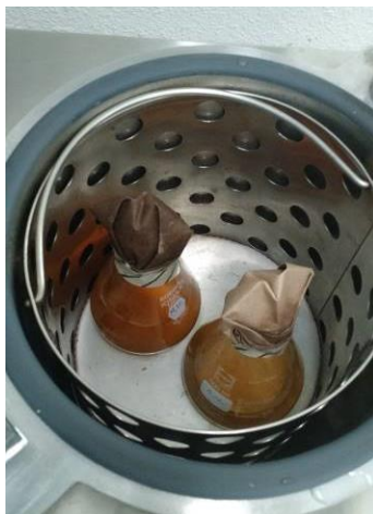
Imagen 3. 2 Esterilización en autoclave de los medios de cultivo. Etapa final.
