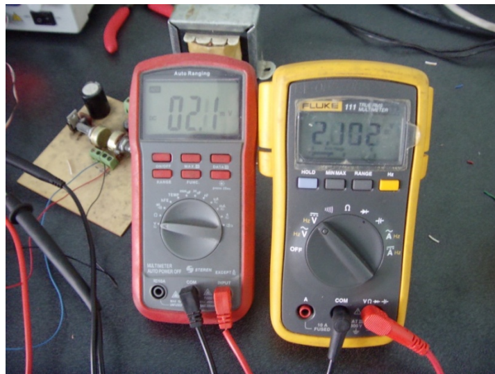
Figura 3.15 Voltaje obtenido después de deformar la barra.
