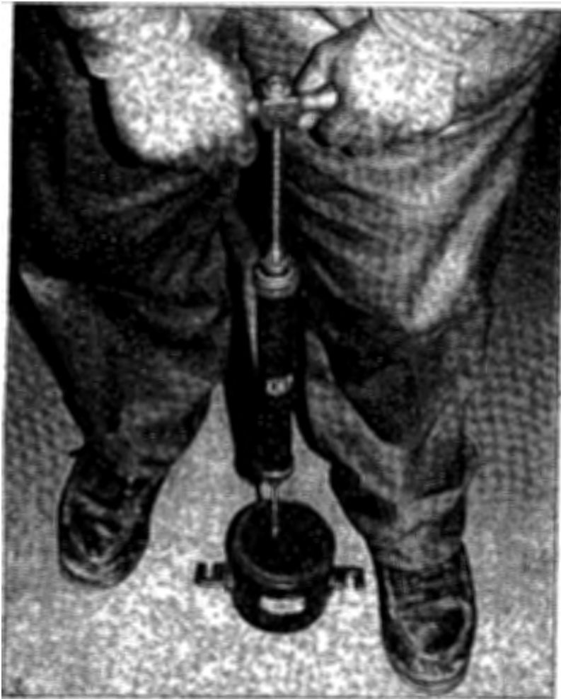
fig. 6.3.4 Ensaye del penetrómetro Proctor en un suelo en estado remoldeado.
