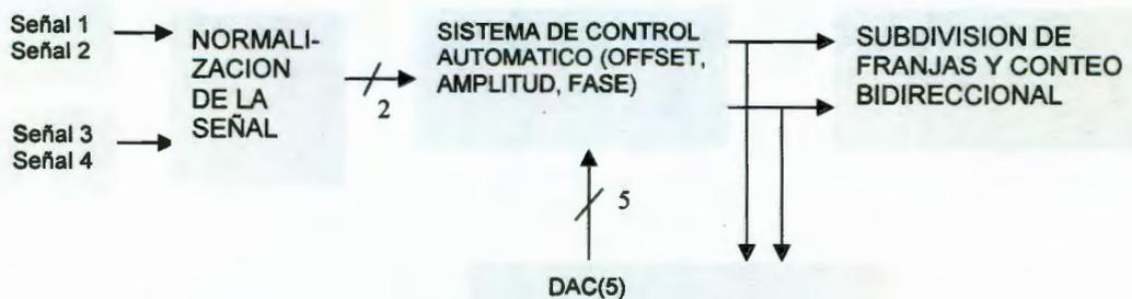
Las señales 1,2, 3 y 4 provenientes del sensor óptico son captadas por los fotodetectores y convertidas a señales eléctricas, estas cuatro señales son senoidales y tienen un desfase entre ellas de 90°, sin embargo, el par de señales 1-2 y 3-4 tienen un desfase de 180°. Existe una etapa de normalización de la señal donde se generan dos señales de salida A y B.
