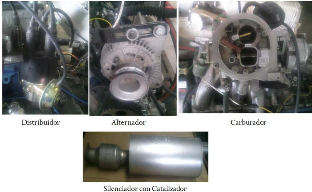
**Fig.3. 18 Colocación de quipos auxiliares.**
