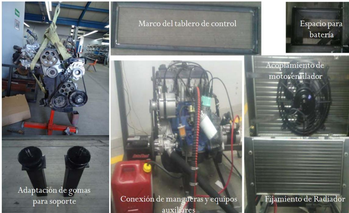
**Fig.3. 19 Acoplamiento y asignación de espacio para equipos auxiliares.**
