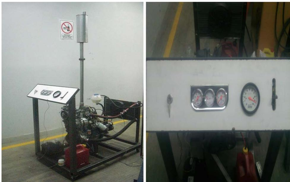
**Fig.4. 2 Módulo y tablero de control terminado.**
