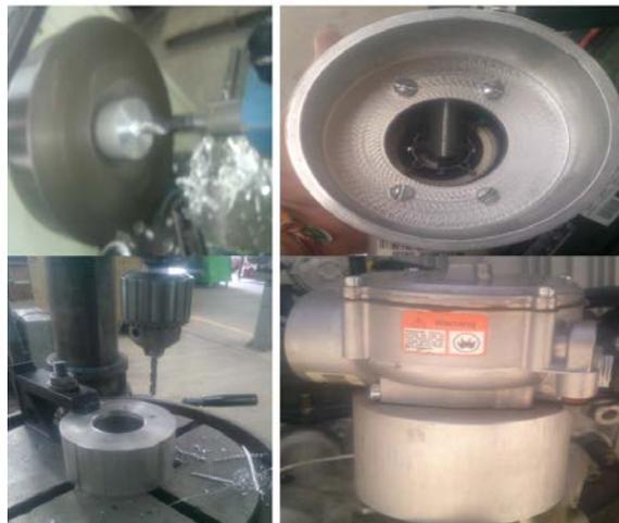
**Fig.3. 24 Construcción de base para mezclador.**
