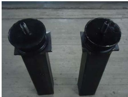
**Fig.3. 17 Adaptación del soporte para motor.**
