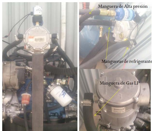
**Fig.3. 25 Conexión de mangueras del equipo de Gas LP.**
