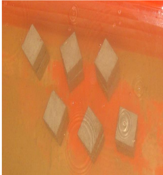
Figura 46. Probetas sometidas a impregnaciones con Cloruro de Sodio en Tanque de almacenamiento (NMX-C-148-ONNCCE-2002).
