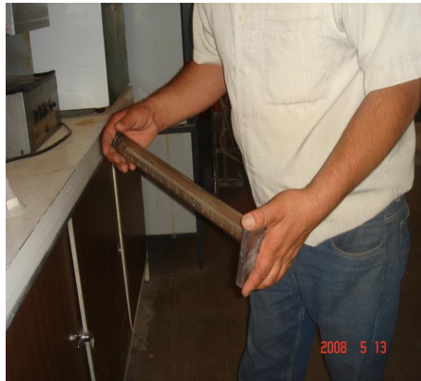
Figura 32. Pasando el tiempo de impregnación se agita de forma horizontal durante 45 seg.
