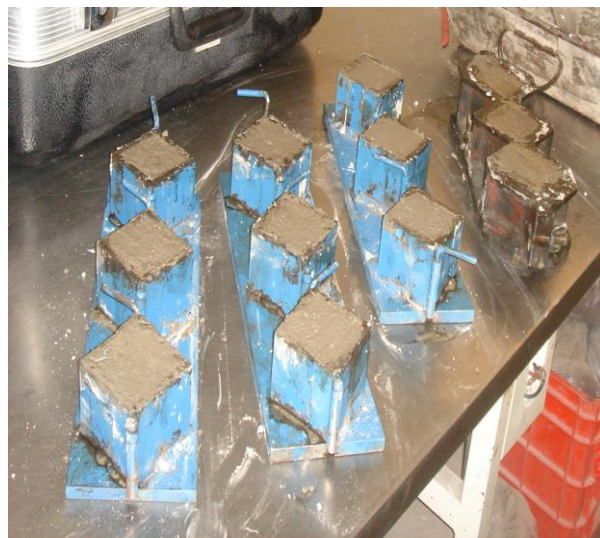
Figura 41. Con una regleta se quita el excedente de cada molde.
