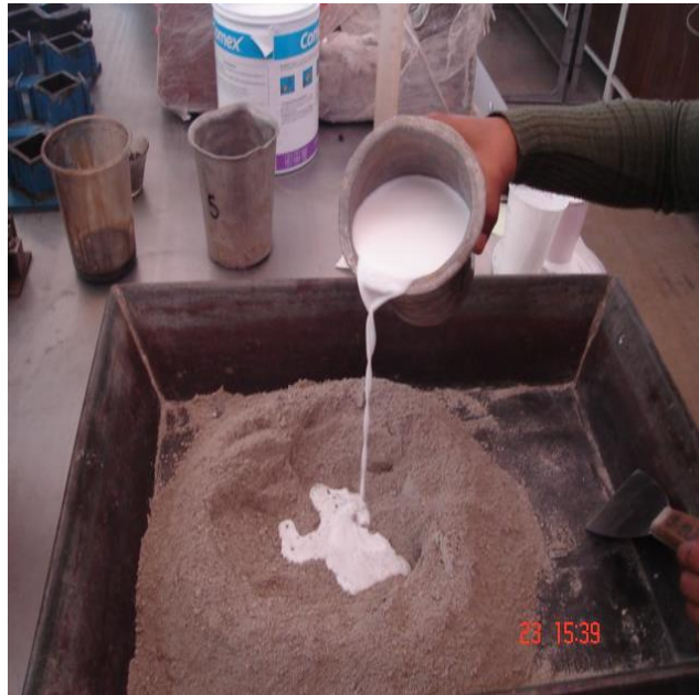
Figura 38. Una vez preparada la arena se vacía la resina en el centro del material.
