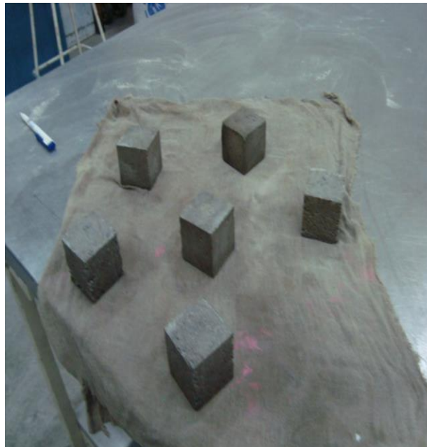
Figura 51. Se mantienen los especímenes cubiertos con un trapo húmedo antes del ensayo.
