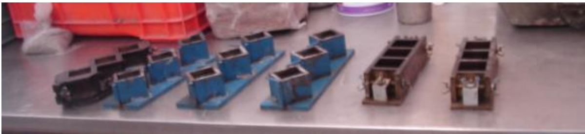
Figura 35. Moldes fijos con capa de aceite mineral (NMX-C-062-1997-ONNCCE).
