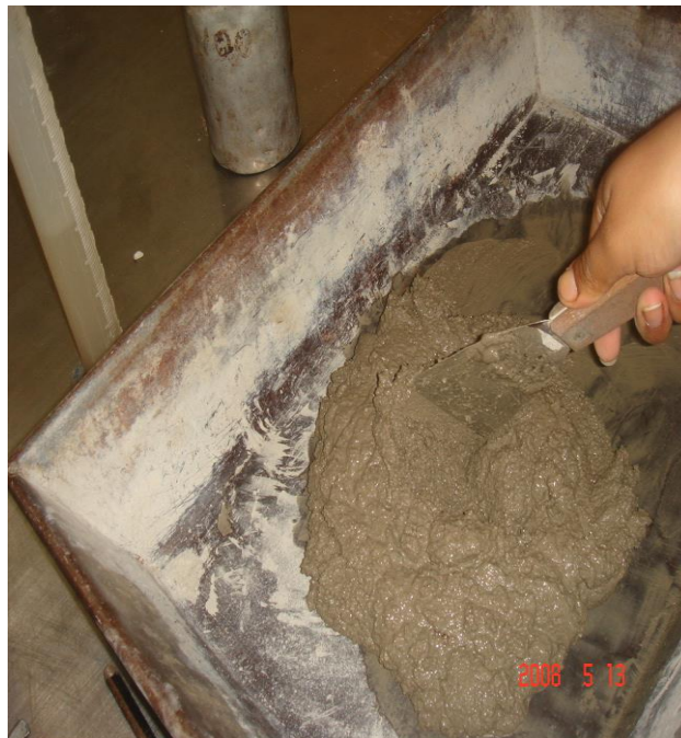
Figura 39. Mezcla de los materiales hasta llegar a la consistencia adecuada en base a la fluidez (Norma NMX-C-144-ONNCCE-2002).
