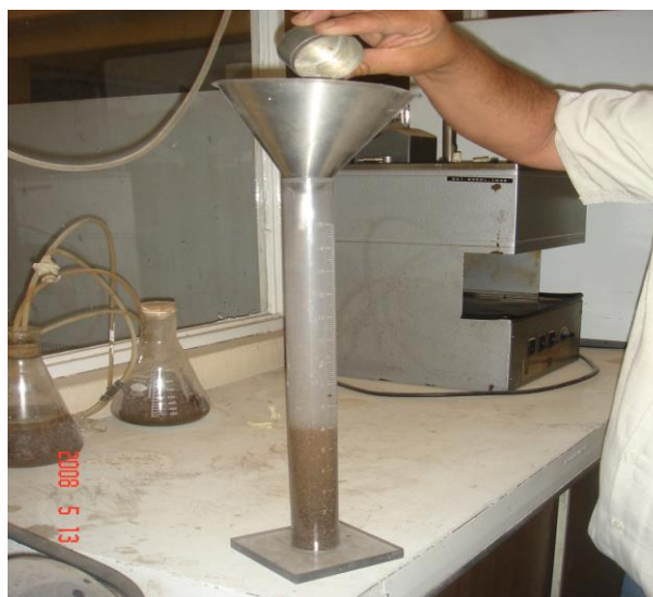
Figura 31. Probeta con 10 cm de solución de trabajo (Cloruro de calcio cristalino, \text{CaCl}_2 \cdot 6\text{H}_2\text{O} , o cloruro de calcio anhidro, \text{CaCl}_2 // Glicerina// Solución de formaldehído// Agua destilada o desmineralizada).
