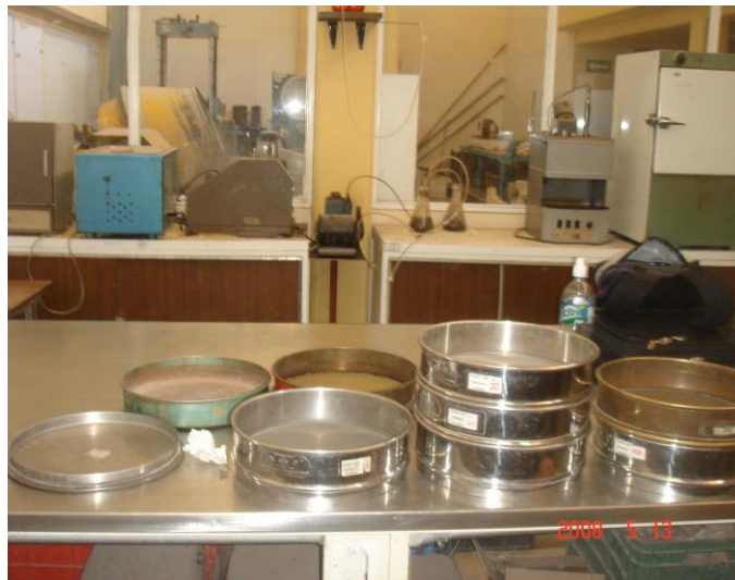
Figura 26. Tapa y charola base de tamices sin residuos de suelos. (Mallas con ancho de entramado; 16, 30, 40, 50, 60, 100, 200 de mayor a menor respectivamente).
