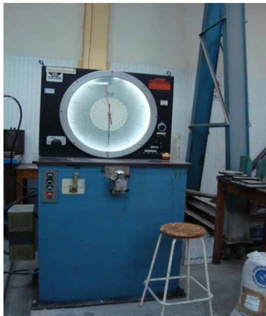
Figura 23. Máquina Universal, Lectura y ensaye a compresión.
