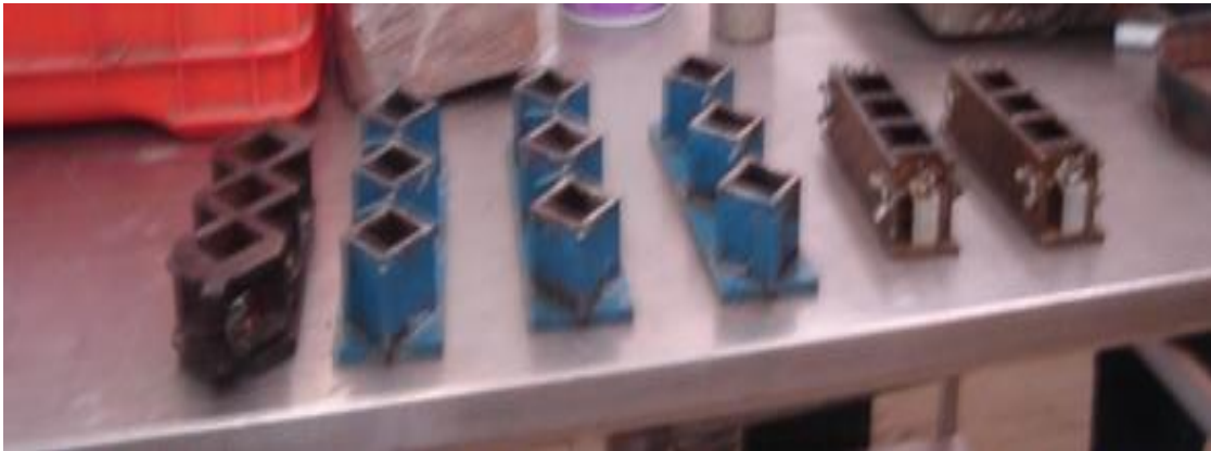
Figura 22. Moldes de acero.
