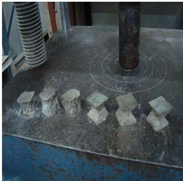
Figura 54. Ensayo del espécimen aplicando la carga de manera gradual hasta llegar a la ruptura.
