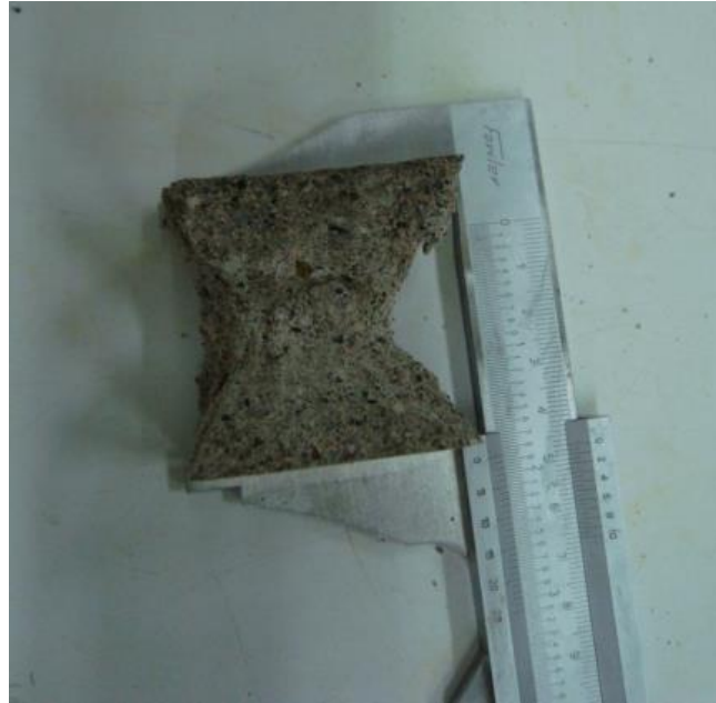
Figura 56. Se toman las dimensiones del espécimen una vez terminado el ensaye.
