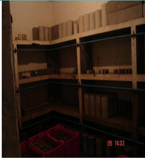
Figura 50. Interior de cuarto húmedo con especímenes en hidratación y tanque de almacenamiento (lo que en obra se le llama curado)
