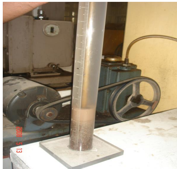
Figura 32. Pasando el tiempo de impregnación se agita de forma horizontal durante 45 seg.
