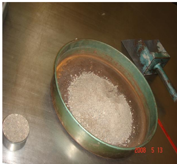
Figura 30. Arena cribada por la malla #4.
