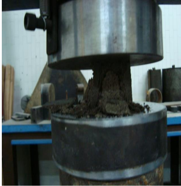
Figura 54. Ensayo del espécimen aplicando la carga de manera gradual hasta llegar a la ruptura.
