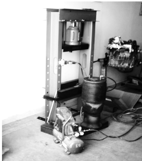
Figura 4.0.1 Banco de pruebas para inflado y desinflado de resorte neumático de prueba.
